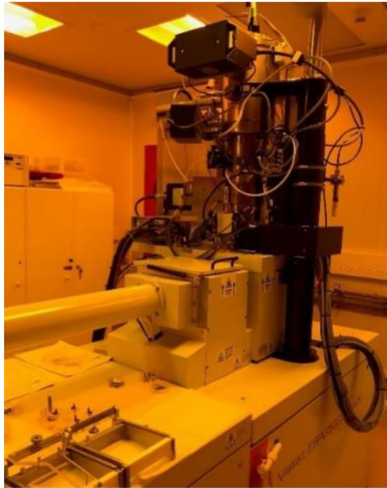
Σχήμα 5.4: Λιθογραφία ηλεκτρονικής δέσμης, ΕΚΕΦΕ Δημόκριτος
