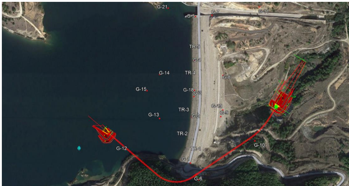
Εικόνα 3.2: Οριζοντιογραφική απεικόνιση γεωτρήσεων και σήραγγας εκτροπής (Google earth)
