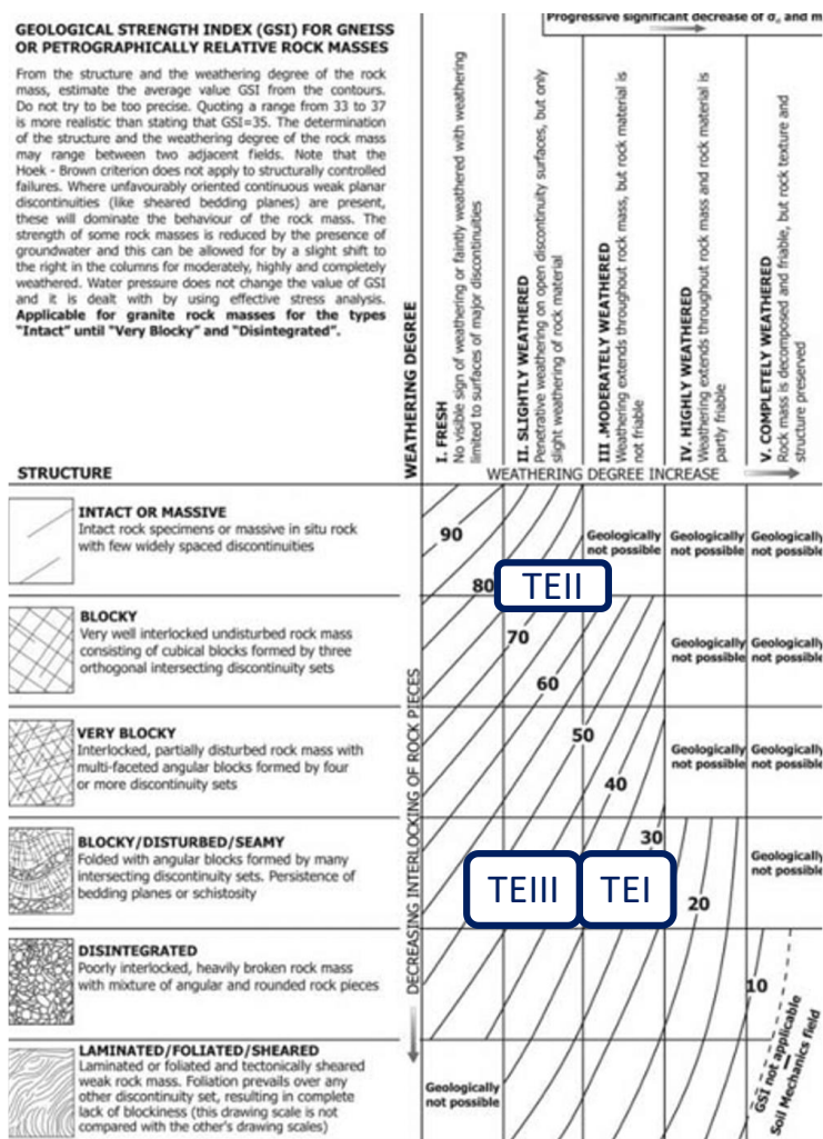
Εικόνα 4.1: Δείκτης γεωλογικής αντοχής GSI για αποσαθρωμένες γνευσιακές βραχώμαζες (V. Marinos, 2007)
