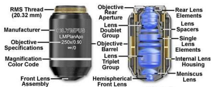
Εικόνα 3.8. Σχηματική αναπαράσταση της εσωτερικής δομής ενός αντικειμενικού φακού.
