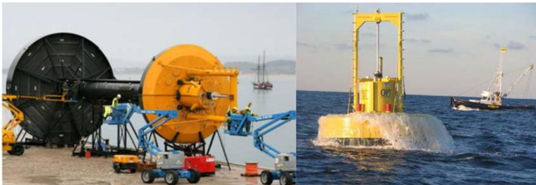
Εικόνα 9 Διάταξη σημειακού κυματικού απορροφητήρα δύο κινούμενων σωμάτων της Ocean Power Technologies (19)
