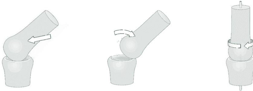
Εικόνα 2.14 Θεμελιώδεις κινήσεις μεταξύ των αρθρικών επιφανειών, από αριστερά προς τα δεξιά, κύλιση, ολίσθηση, περιστροφή.
