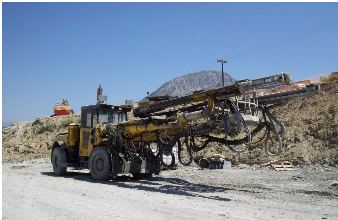
Εικόνα 6.3: Διατρητικό μηχάνημα υπογείων Jumbo τύπου Atlas Copco
