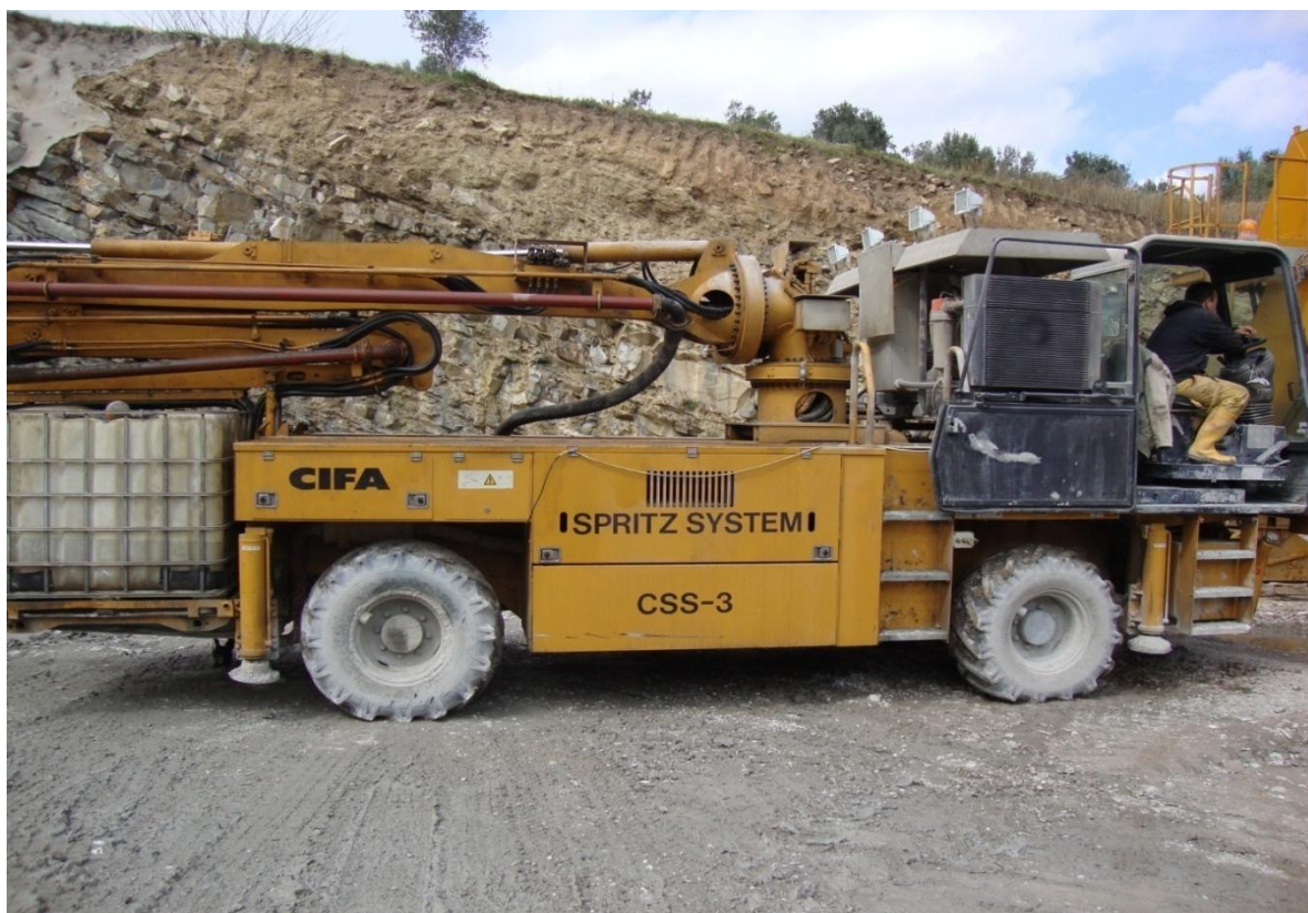
Εικόνα 3.1: Πρέσα (με ειδική αντλία) εκτοξευόμενου σκυροδέματος
