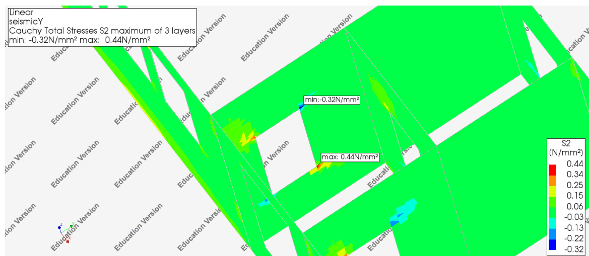
Εικόνα 78: Κύριες τάσεις S2 υφιστάμενο seismicY (μεγέθυνση) [17]
