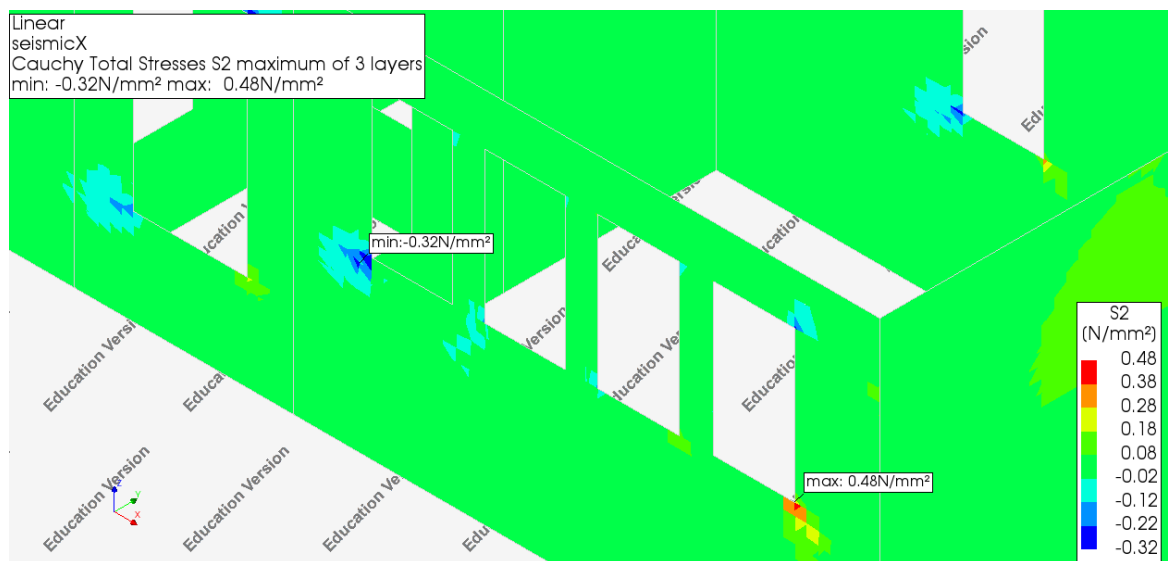
Εικόνα 118: Κύριες τάσεις S2 πλάκα ΟΣ seismicX (μεγέθυνση) [17]
