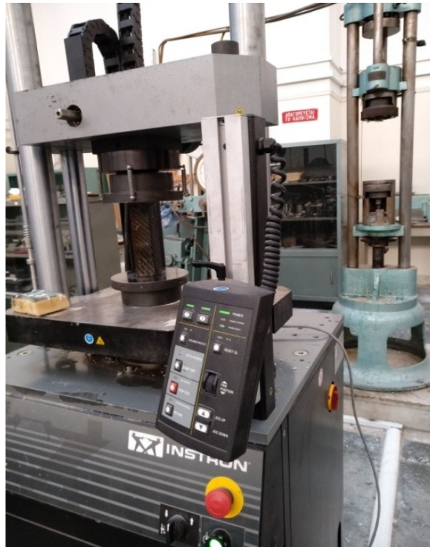
7.2.1-1. Εργαστηριακή διάταξη μέτρησης θλιπτικής αντοχής Instron.
