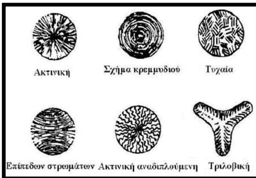
Εικόνα 3.2-3. Εγκάρσια μικρο-δομή ινών άνθρακα από πίσσα (Πηγή: Ruland, 1990).
