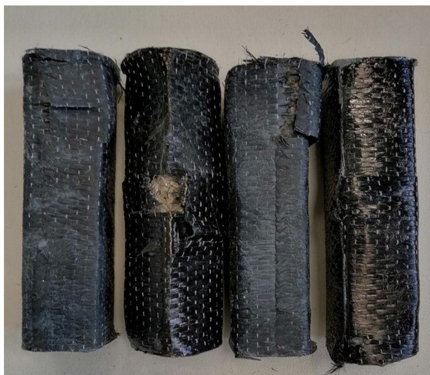
Εικόνα 7.3.1-1. Θραυσμένα με μονοαξονική θλίψη σύνθετα FRP υλικά τσιμεντοκονιάματος με ενίσχυση υφασμάτων ινών άνθρακα μονής κατεύθυνσης και εποξειδική ρητίνη.
