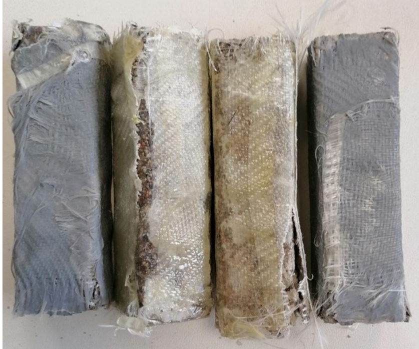
Εικόνα 7.3.2-1. Θραυσμένα με μονοαξονική θλίψη σύνθετα FRP υλικά τσιμεντοκονιάματος με ενίσχυση υφασμάτων υάλου διπλής κατεύθυνσης και εποξειδική ρητίνη.
