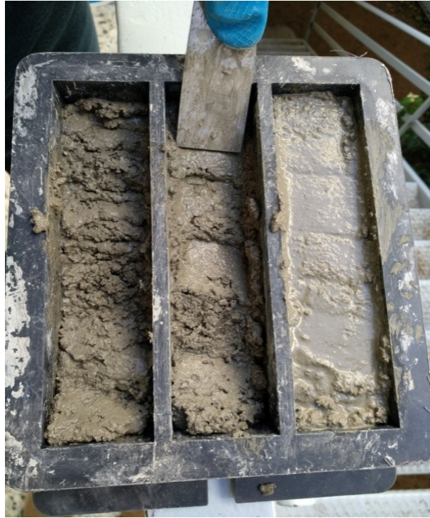
Εικόνα 6.1.1-3. Μεταφορά και κατανομή του σκυροδέματος στο καλούπι παραγωγής δοκιμίων.
