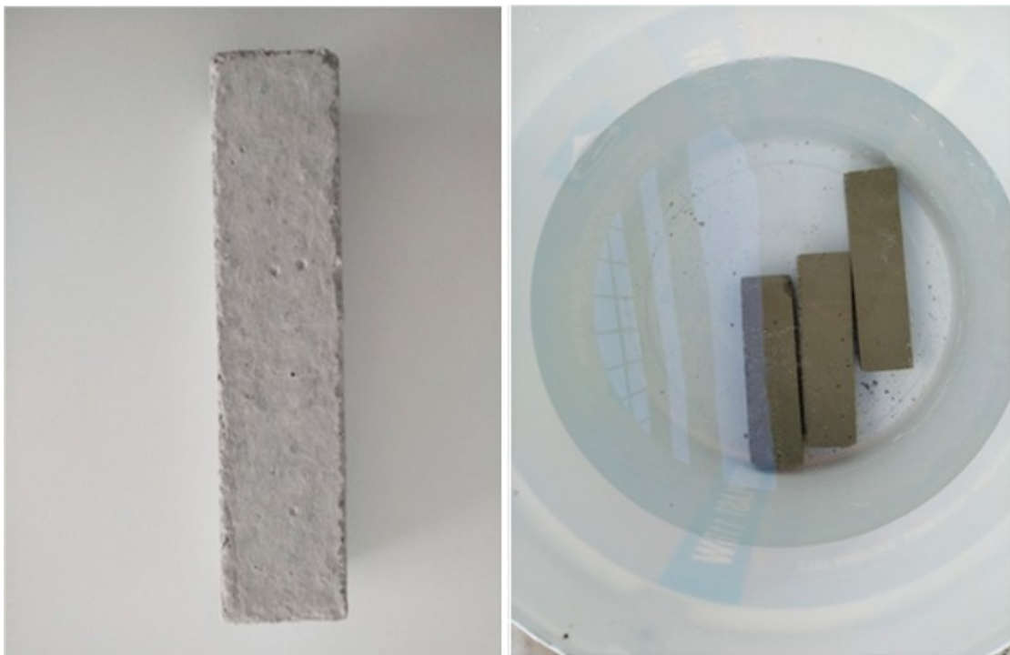
Εικόνα 6.1.1-2. Δοκίμια τσιμέντου για το πειραματικό μέρος της διατριβής (αριστερά) δοκίμια τσιμέντου τοποθετημένα σε νερό (δεξιά).
