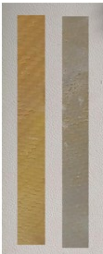
6.1.10-1. Σύνθετα ξηρής (δεξιά) και υγρής (αριστερά) εποξειδικής ρητίνης-ινών Kevlar διπλής κατεύθυνσης (twill).
