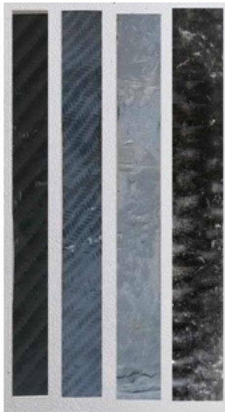
6.1.5-4. Σύνθετα εποξειδικής ρητίνης-ινών άνθρακα (από αριστερά προς τα δεξιά: υγρή και ξηρή εποξειδική ρητίνη με υφάσματα διπλής κατεύθυνσης (twill) και σύνθετα ξηρής και υγρής εποξειδικής ρητίνης- με φάσματα μονής κατεύθυνσης).
