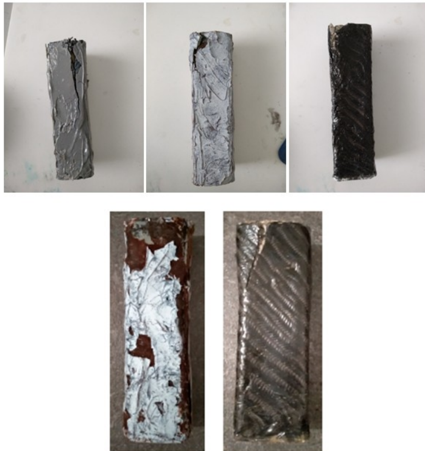
Εικόνα 7.3.5-1. Επιφανειακές αποκολλήσεις σε δοκίμια με τεχνητή μέθοδο γηρασμένα επί 16 ημέρες.
