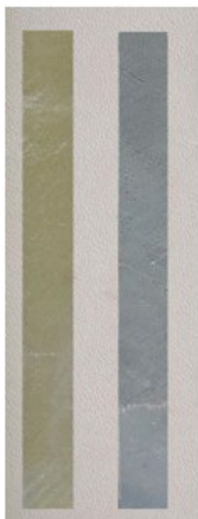
6.1.9-1. Σύνθετα ξηρής (δεξιά) και υγρής (αριστερά) εποξειδικής ρητίνης-ινών υάλου διπλής κατεύθυνσης (twill).
