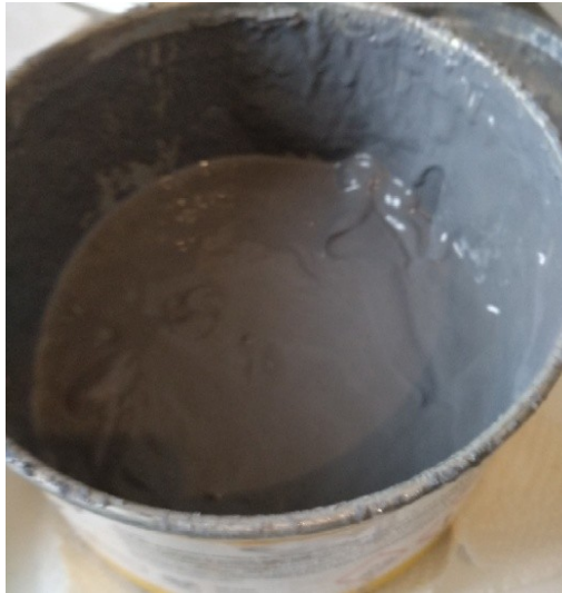
6.1.4-2. Μίγμα Εποξειδικής ρητίνης ξηρού τύπου SINTECNO SINMAST P103.
