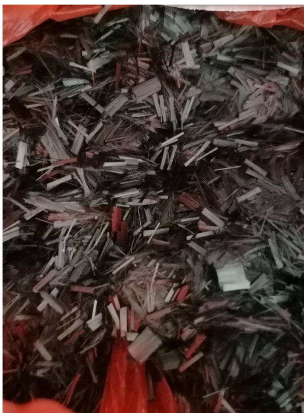
Εικόνα 6.1.1-6. Ψιλοκομμένες (chopped) ίνες άνθρακα.
