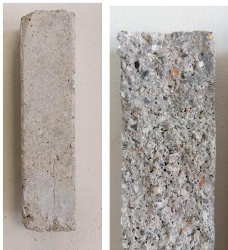
Εικόνα 6.1.1-5. Δοκίμια τσιμέντου (αριστερά: σκέτο, δεξιά: με chopped CF).
