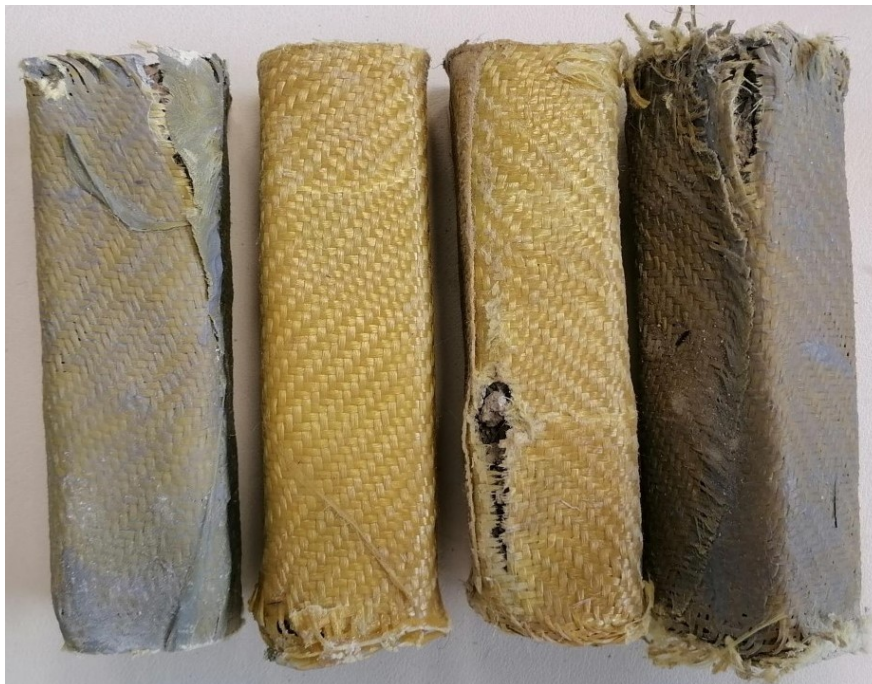
Εικόνα 7.3.2-2. Θραυσμένα με μονοαξονική θλίψη σύνθετα FRP υλικά τσιμεντοκονιάματος με ενίσχυση υφασμάτων Kevlar διπλής κατεύθυνσης και εποξειδική ρητίνη.
