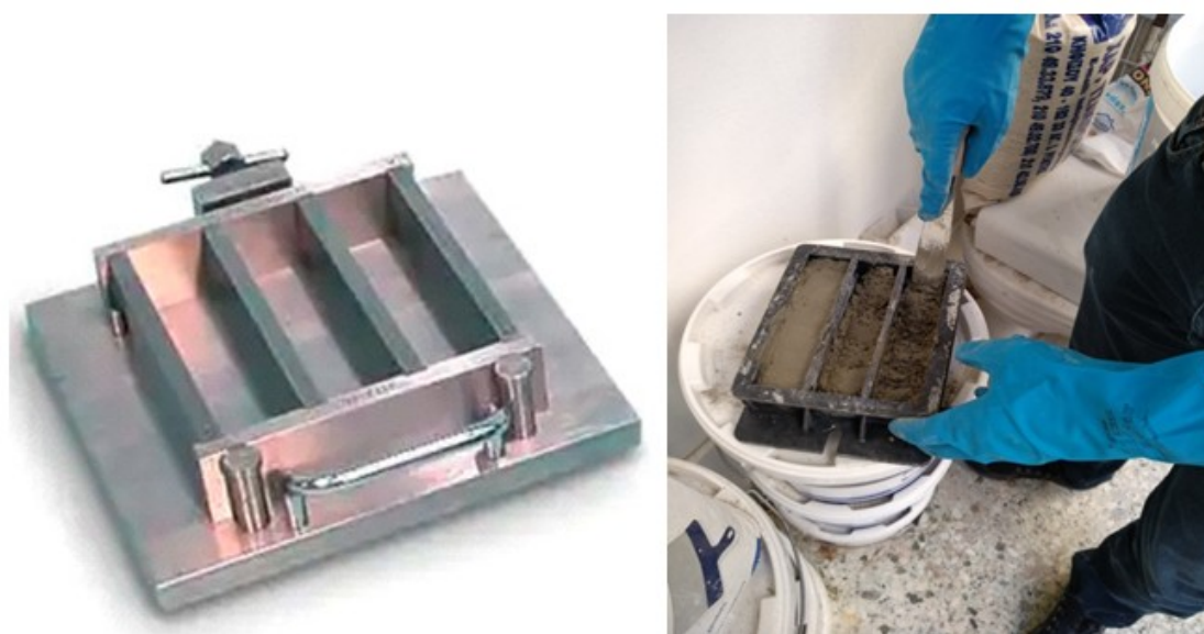
Εικόνα 6.1.1-1. Καλούπι κατασκευής δοκιμών τσιμέντου βάσει EN196-1(αριστερά) τοποθέτηση μίγματος εντός καλουπιού παραγωγής δοκιμών (δεξιά).
