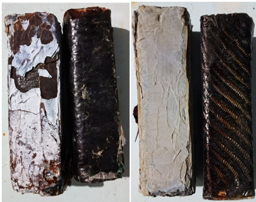
6.2-2. Τεχνητώς γηρασμένα δοκίμια τσιμέντου με υφάσματα ινών άνθρακα.
