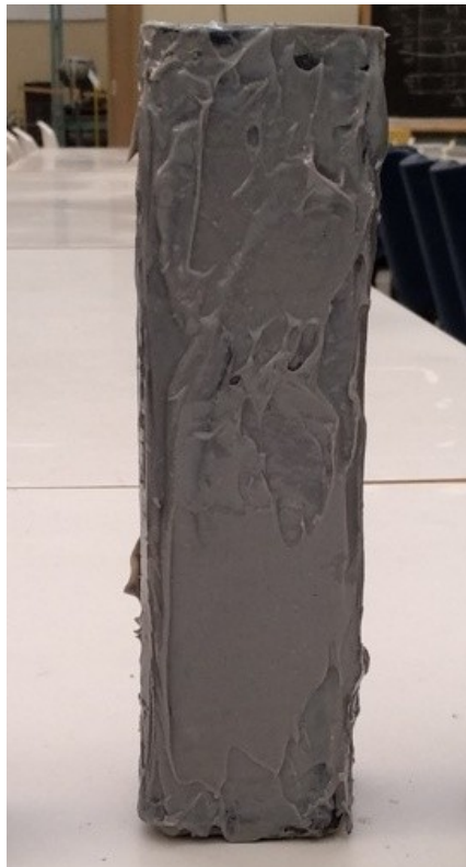
Εικόνα 6.1.2-3. Δοκίμιο σκυροδέματος ενισχυμένο με ύφασμα ινών άνθρακα διαγώνιας πλέξης (twill) μια εποξειδική ρητίνη ξηρού τύπου.
