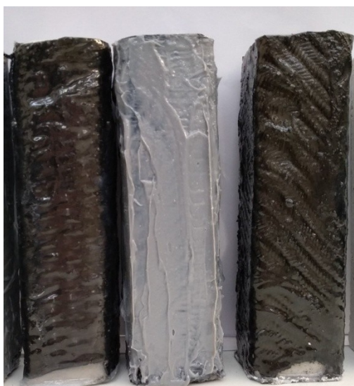
Εικόνα 6.1.3-2. Δοκίμιο σκυροδέματος ενισχυμένο με ύφασμα ινών μονής πλέξης με υγρού τύπου εποξειδική ρητίνη (αριστερά), δοκίμιο σκυροδέματος ενισχυμένο με ύφασμα ινών άνθρακα διαγώνιας πλέξης (twill) με εποξειδική υγρού τύπου εποξειδική ρητίνη (δεξιά).
