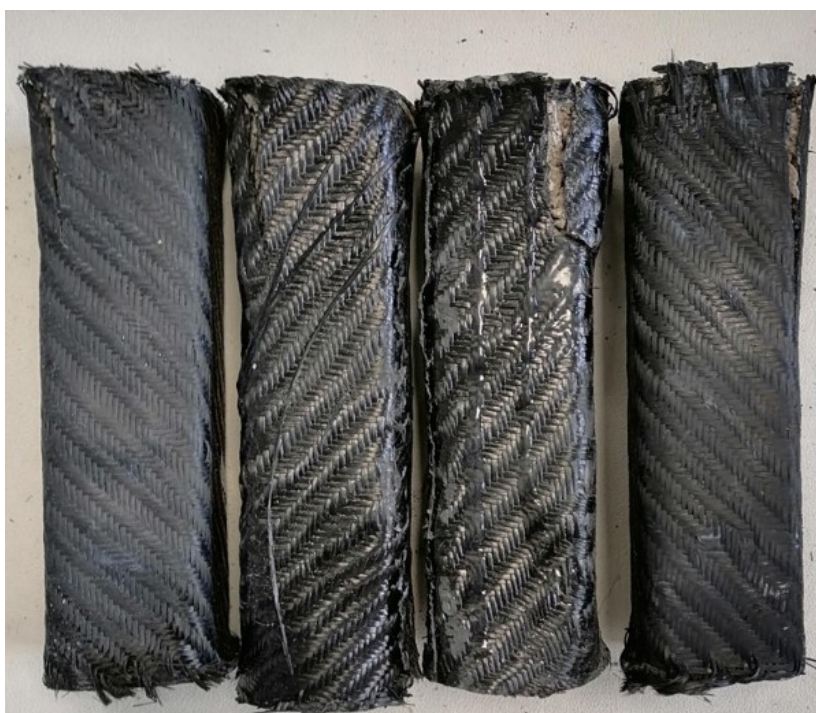
Εικόνα 7.3.1-2. Θραυσμένα με μονοαξονική θλίψη σύνθετα FRP υλικά τσιμεντοκονιάματος με ενίσχυση υφασμάτων ινών άνθρακα διπλής κατεύθυνσης και εποξειδική ρητίνη.
