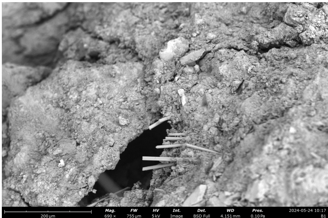
Εικόνα 8.1.3-3. Απεικόνιση (SEM) σε μεγέθυνση×690 για το δοκίμιο τσιμεντοκονιάματος με ίνες άνθρακα μικρού μήκους.
