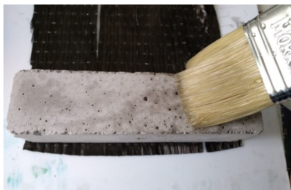
Εικόνα 6.1.3-1. Επίστρωση επιφανειών δοκιμίου με αστάρι.
