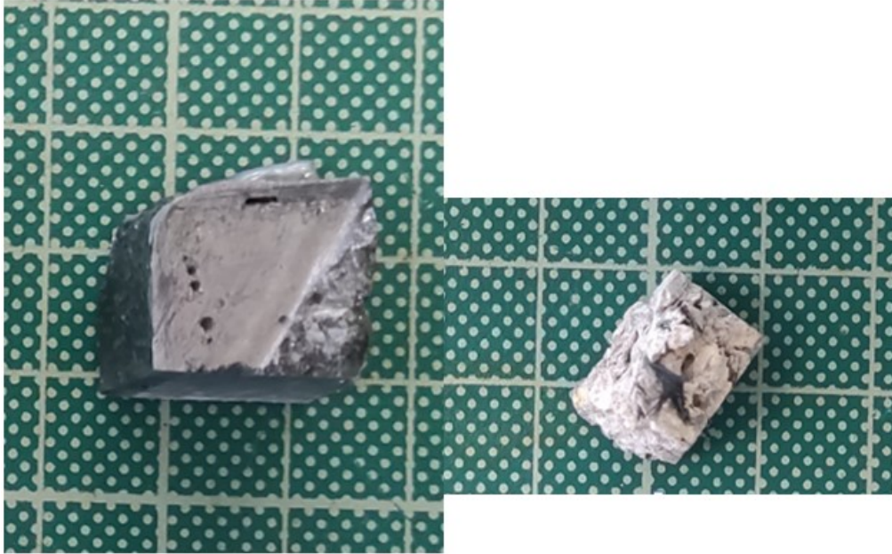
Εικόνα 8.1.2-2. Δείγματα συνθέτων υλικών τσιμεντοκονιάματος με ενίσχυση ινών άνθρακα και υγρή εποξειδική ρητίνη (αριστερά) και τσιμέντου με ίνες άνθρακα μικρού μήκους (δεξιά).
