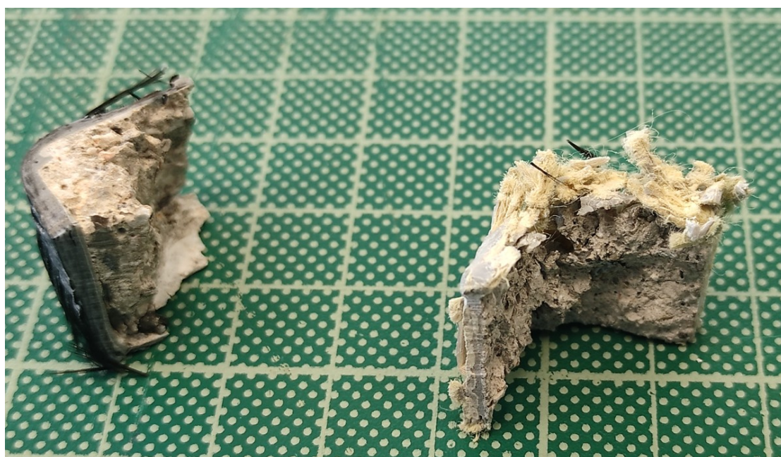
Εικόνα 8.1.2-1. Δείγματα συνθέτων υλικών τσιμεντοκονιάματος με ενίσχυση ιών άνθρακα (αριστερά) και Kevlar και ξηρή εποξειδική ρητίνη (δεξιά).
