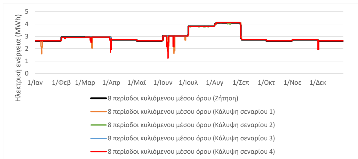
Σχήμα 6.29 Κυλιόμενος μέσος όρος (8 τριώρων) ποσοστού κάλυψης αναγκών ηλεκτρικής ενέργειας από το ΥΣΕ, ανά σενάριο, για το διάστημα ενός έτους.
