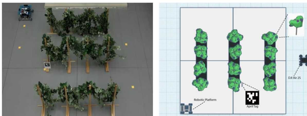
Εικόνα 1-10: Πειραματική διάταξη συνθετικού αμπελώνα στο Εργαστήριο Αυτομάτου Ελέγχου.
