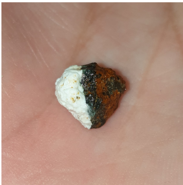
Εικόνα 4.3: Χαρακτηριστικό παράδειγμα ενδιάμεσου, μη αποδεσμευμένου τεμαχίου μεγέθους \approx 12\text{mm}
