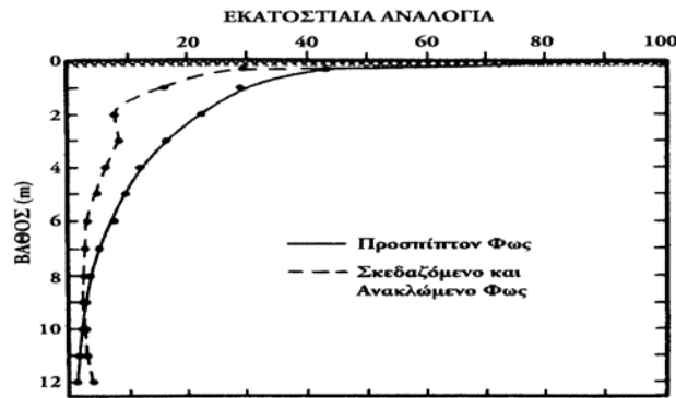
Εικόνα 3.6 - Σύγκριση της διείσδυσης του προσπίπτοντος φωτός συναρτήσει του βάθους, σε σχέση με το φως που υφίσταται σκεδασμό. Λίμνη Lawrence (Wetzel 2001).
