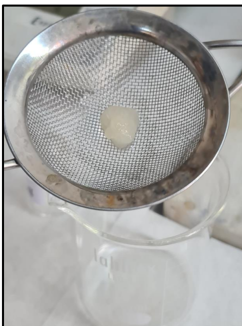
Εικόνα. 23 Διαδικασία απομάκρυνσης του HCl ,έτσι ώστε να είναι επιτεύξιμη η ζύγιση της ευτηκτογέλης.
