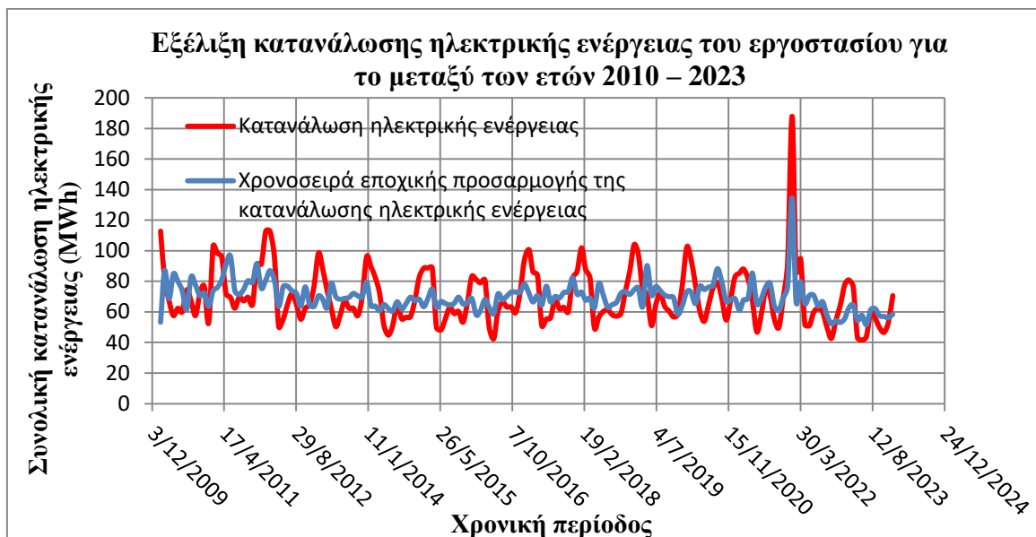
Σχήμα 23: Σύγκριση μεταξύ της συνολικής κατανάλωσης ηλεκτρικής ενέργειας και της χρονοσειράς εποχικής προσαρμογής του Εργοστασίου
