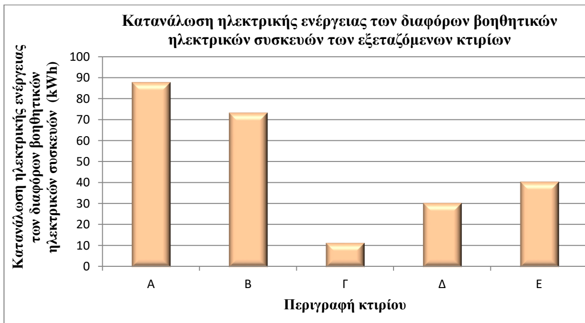
Σχήμα 5: Κατανάλωση ηλεκτρικής ενέργειας των διαφόρων βοηθητικών ηλεκτρικών συσκευών των εξεταζόμενων κτιρίων
