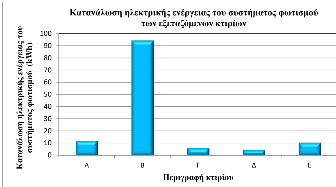
Σχήμα 4: Κατανάλωση ηλεκτρικής ενέργειας του συστήματος φωτισμού των εξεταζόμενων κτιρίων
