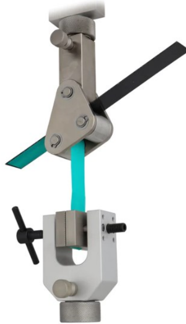
Εικόνα 41: Διαδικασία διενέργειας “Floating roller peel strength” κατά EN2243-2
