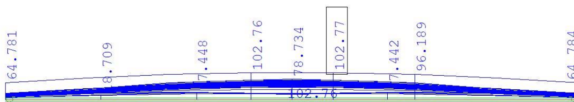
Σχήμα 8.2 Τάσεις Von Mises διαδοκίδων σιδηροδρομικού κλάδου
