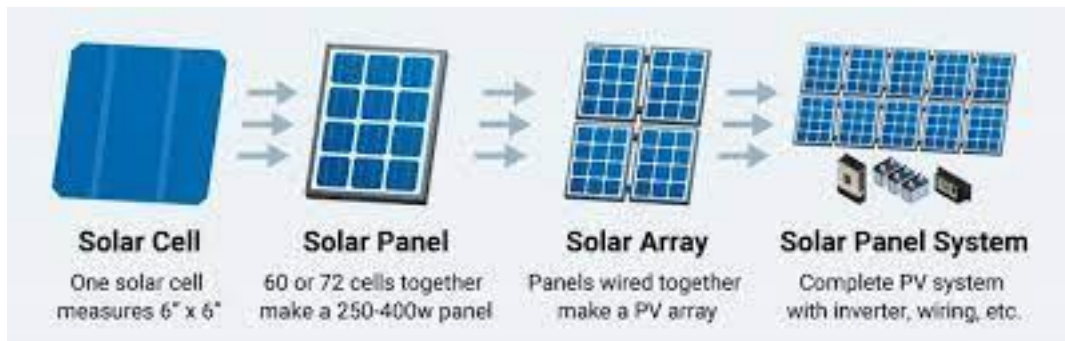
Εικόνα 6 Τα μέρη ενός φωτοβολταϊκού (Zeeshan Hyder, 2023).
