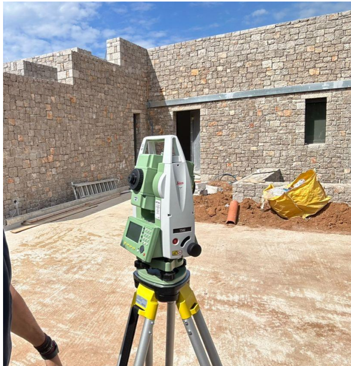
Εικόνα 2-1: Γεωμετρική αποτύπωση κτηρίου από λιθοδομή.
