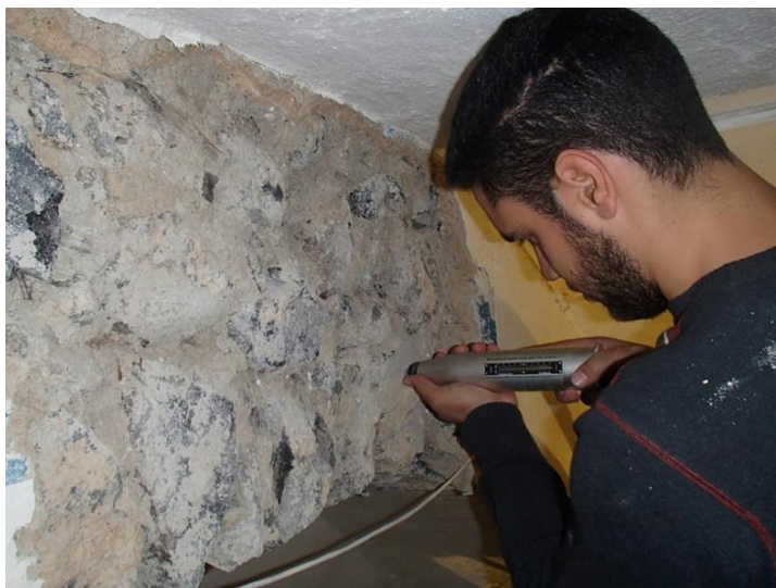
Εικόνα 2-8: Εφαρμογή μεθόδου κρουσιμετρήσεων.
