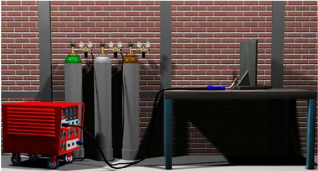
Εικόνα 15. Τυπική διάταξη εξοπλισμού της μεθόδου MIG(62)
