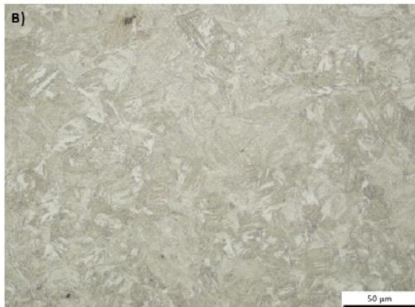
Εικόνα 34. Θερμικά επηρεασμένες ζώνες για την συγκόλληση του τμήματος Tube-Tube στο A σασί. Βλέπουμε 2 παρόμοιες βελονοειδείς δομές με σχετικά κοντινές σκληρότητες. Μικροδομή μπεινιτικού φερρίτη που συναντήθηκε και σε προηγούμενες μικροφωτογραφίες.
