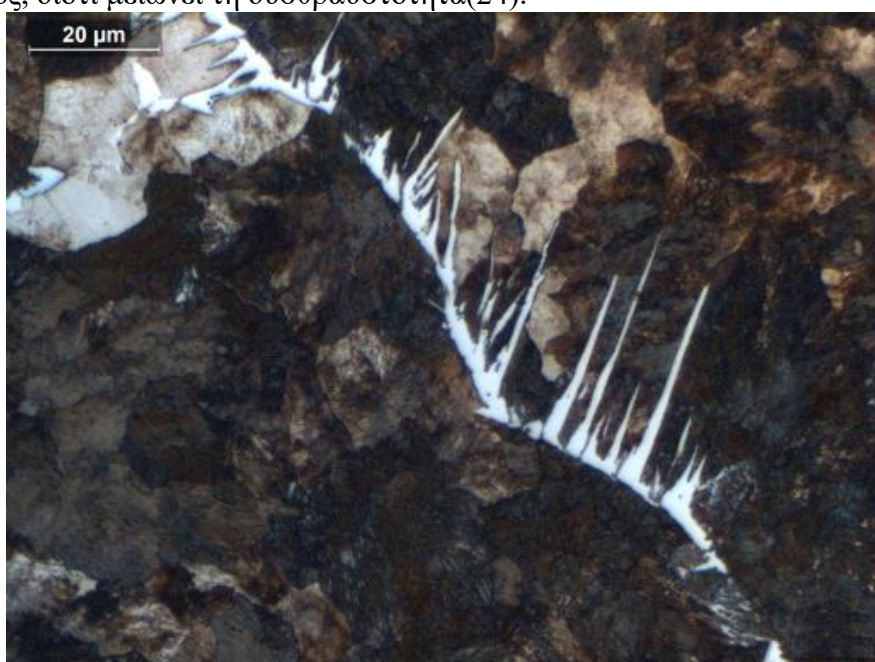
Εικόνα 7. Widmanstätten φερρίτης πυρήνωμένος στα όρια του πρώην Ωστενίτη σε περλιτική μήτρα. (33)
