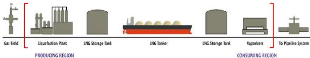
Εικόνα 6: LNG : αλυσίδα λειτουργιών παραγωγής και κατανάλωσης (Energy API, 2015)
