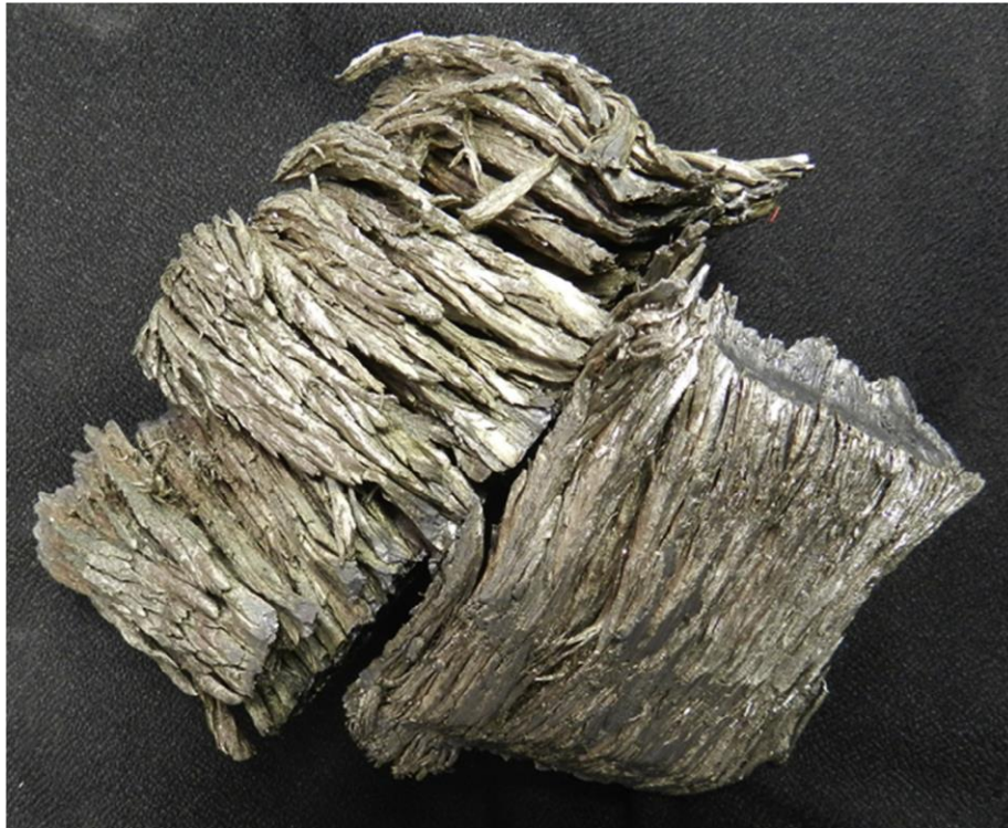
Σχ. 2.6: Σαμάριο που έχει παραχθεί με λανθανοθερμική αναγωγή.
