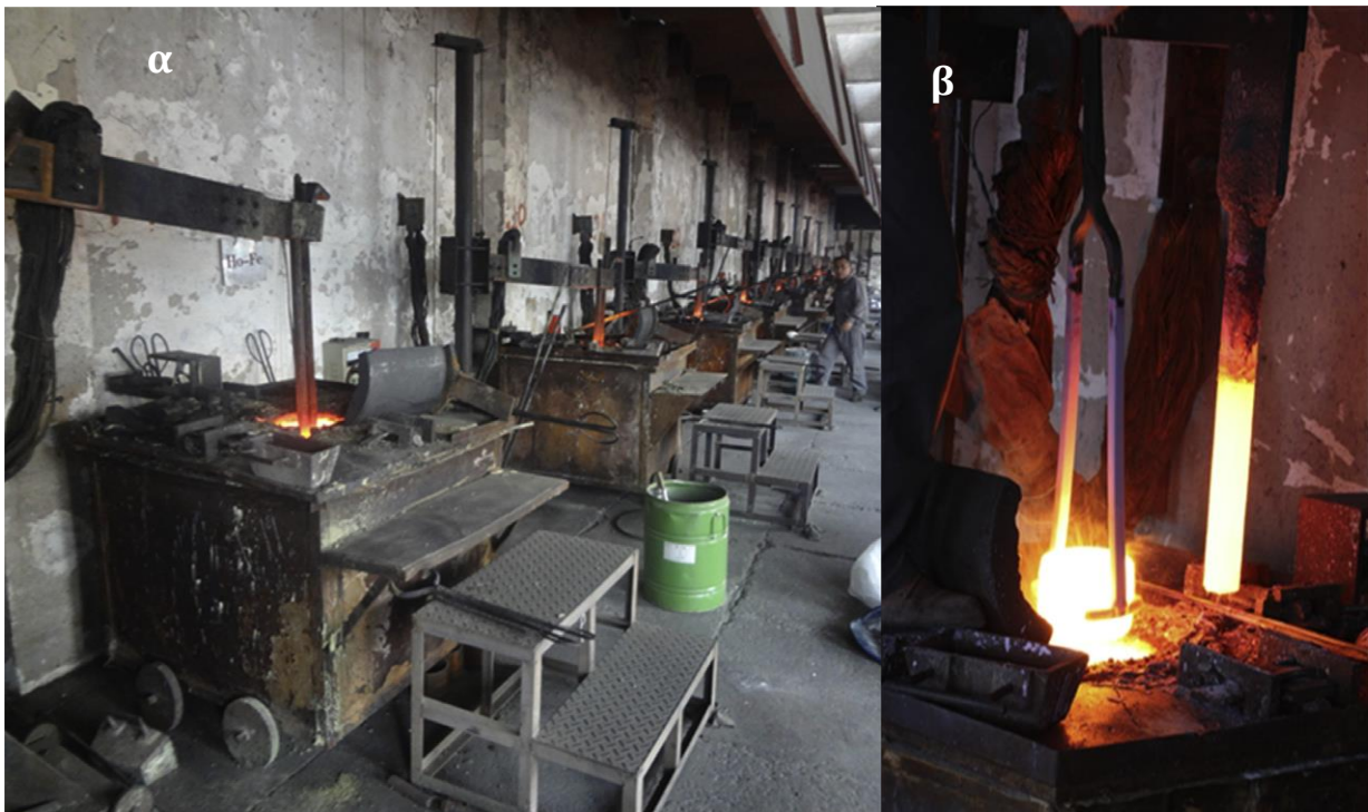
Σχ. 2.4: (α) Φωτογραφία μεταλλουργείου σπάνιων γαιών και μεταλλουργιών ηλεκτραπόθεσης. Τα απαέρια συλλέγονται μέσω απαγωγών αερίων άνωθεν των κελιών. (β) Φωτογραφία που δείχνει βυθισμένο μεταλλικό χωνευτήριο που ανυψώνεται από το ηλεκτρολυτικό λούτρο.
