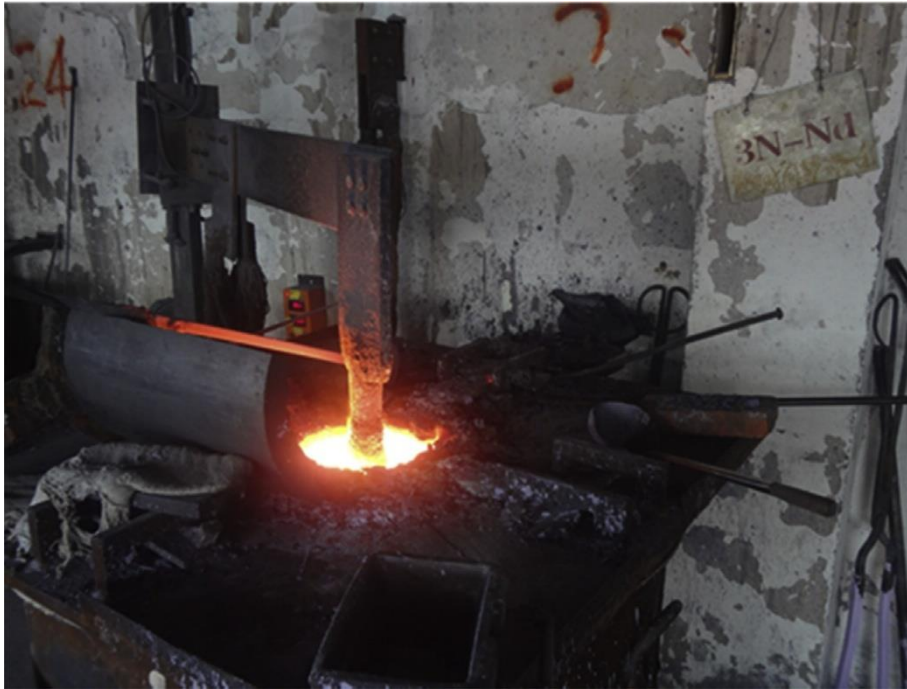
Σχ 2.1: Ηλεκτρολυτικό κελί τηγμένου άλατος (1050 °C) για παραγωγή 99,9% μάζας καθαρού τηγμένου νεοδυμίου (βλ. σήμανση στον τοίχο). Η κεντρική κάθοδος βολφραμίου γίνεται αντιληπτή, η οποία περιβάλλεται από τέσσερις βυθισμένες ανόδους γραφίτη.
