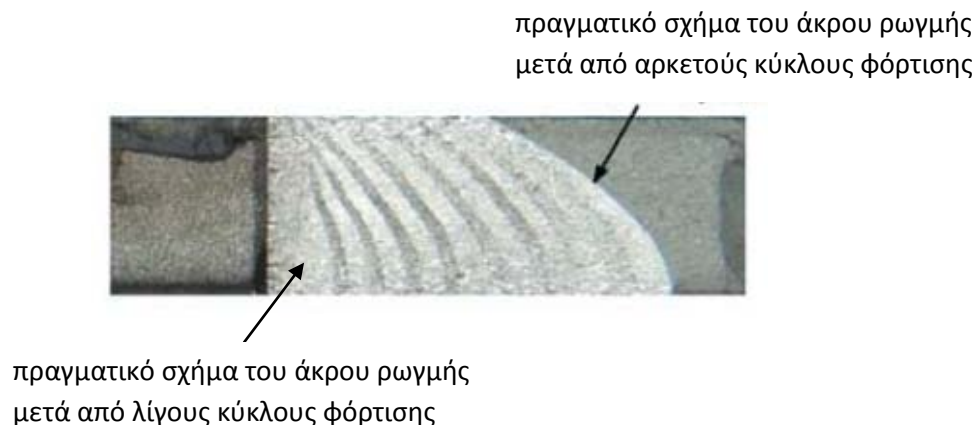
Σχήμα 1.20: Μορφή του μετώπου ρωγμής για μονόπλευρα ενισχυμένο δοκίμιο.
