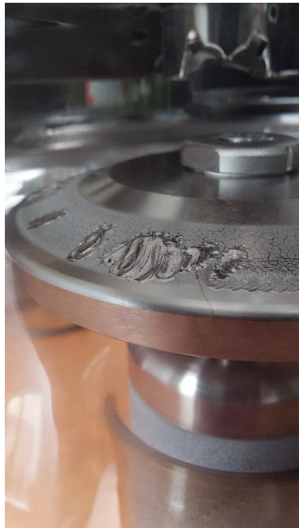
Εικόνα 3.2-2. Λεπτομέρεια του δίσκου της περιστρεφόμενης ανόδου της ακτινολογικής λυχνίας του Σχ. 3.2-1. Διακρίνονται τα βαθουλώματα, αποτέλεσμα της πρόσκρουσης των ηλεκτρονίων που εκπέμπονται από την κάθοδο.
