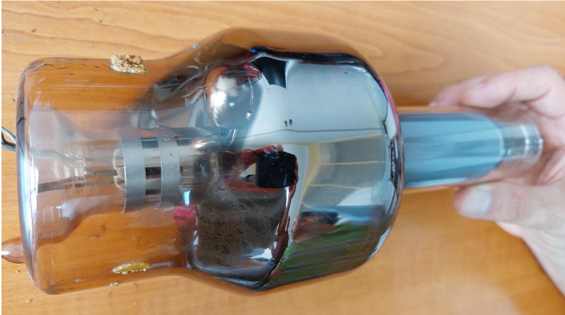
Εικόνα 3.2-3. Λεπτομέρεια της ακτινολογικής λυχνίας του Σχ. 3.2-1. Διακρίνεται το λεπτό υμένιο (μαύρισμα) πάνω στο γυάλινο περίβλημα της λυχνίας, ως αποτέλεσμα της εξάτμισης του υλικού της ανόδου.
