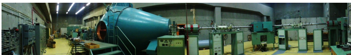
Σχήμα 4: Ο επιταχυντής 5.5 MV Van de Graaff του ΕΚΕΦΕ “Δημόκριτος”
