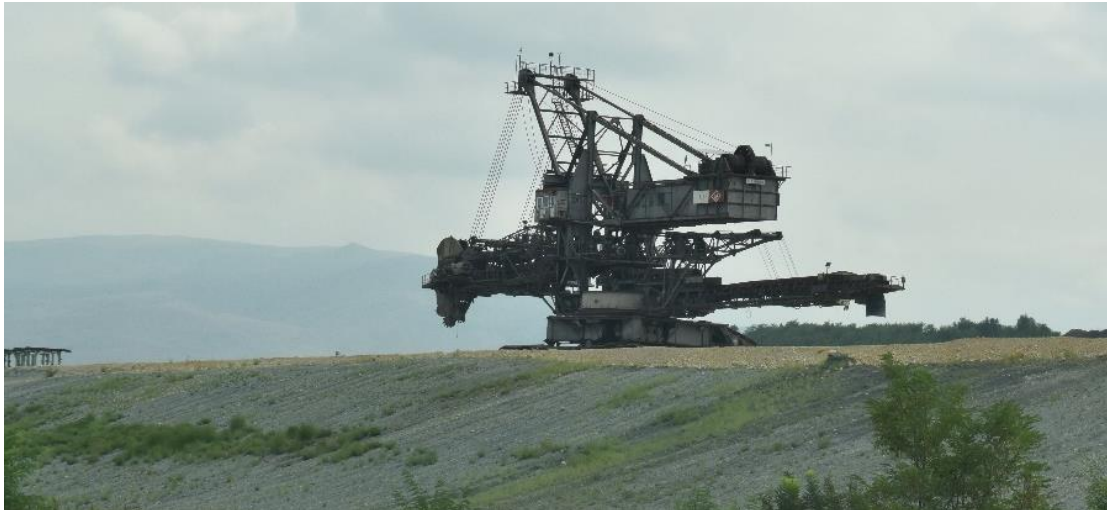
Εικόνα 7-7. Καδοφόρος εσκαφέας εκτός λειτουργίας (πλησίον Πτολεμαΐδα-V). Πηγή: Προσωπικό αρχείο (2021)
