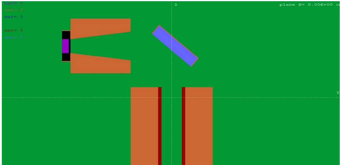
Σχήμα 7.28: Απεικόνιση της διάταξης 3.1.50: στη θέση 3 (απόσταση βάσης ανιχνευτή – βάσης δείγματος 8cm), με κωνικό κατευθυντή, για κλίση δείγματος 50°.
