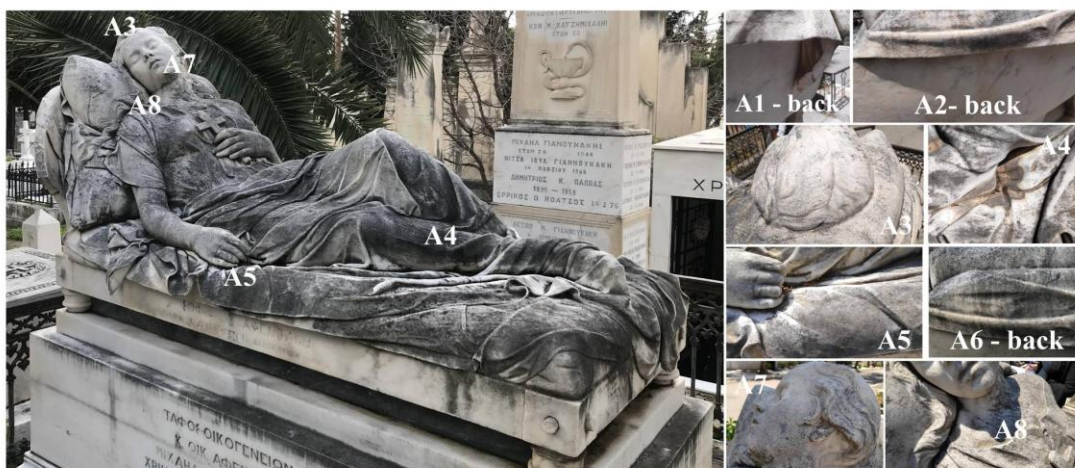
Εικόνα 47: Σημεία δειγματοληψίας από το Μνημείο Αφεντάκη (Κοιμωμένη του Χαλεπά ), Α΄ Νεκροταφείο Αθηνών
