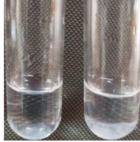
Εικόνα 52: Σχηματισμός ανθρακικού ασβεστίου με τη δράση του ενζύμου καρβονική ανυδράση. Αριστερά παρουσιάζεται το τυφλό δείγμα της αντίδρασης και δεξιά το αποτέλεσμα της δράσης του ενζύμου καρβονική ανυδράση.
