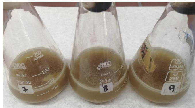
Εικόνα 53: Εναπόθεση CaCO 3 στα δείγματα λίθινων επιφανειών των επιδεικτικών μνημείων
