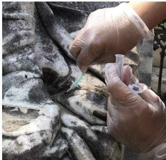
Εικόνα 51: Λήψη βιολογικού δείγματος μέσω της μεθόδου swabbing με χρήση αποστειρωμένου βαμβακοφόρου στείλου ( swab ), από περιοχή με εμφανή μαύρη και λευκή διάβρωση του αγάλματος “Κοιμωμένη του Χαλεπά” του μνημείου της Αφεντάκη στο Α΄ Νεκροταφείο Αθηνών.
