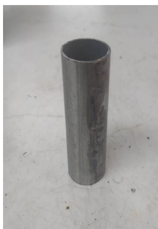
Εικόνα 10: Τελική διαμόρφωση των δοκιμίων για την μελέτη της αξονικής συμπίεσης τους
