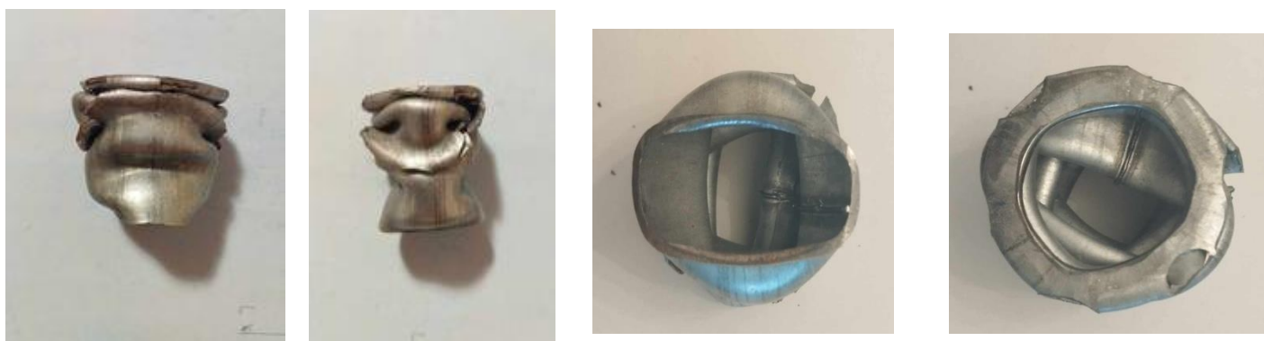
Εικόνα 39: Δοκίμια μετά την ολοκλήρωση της θλίψης
