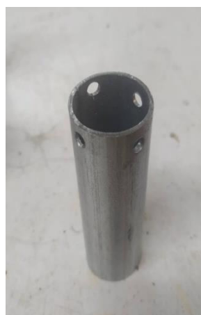
Εικόνα 10: Τελική διαμόρφωση των δοκιμίων για την μελέτη της αξονικής συμπίεσης τους
