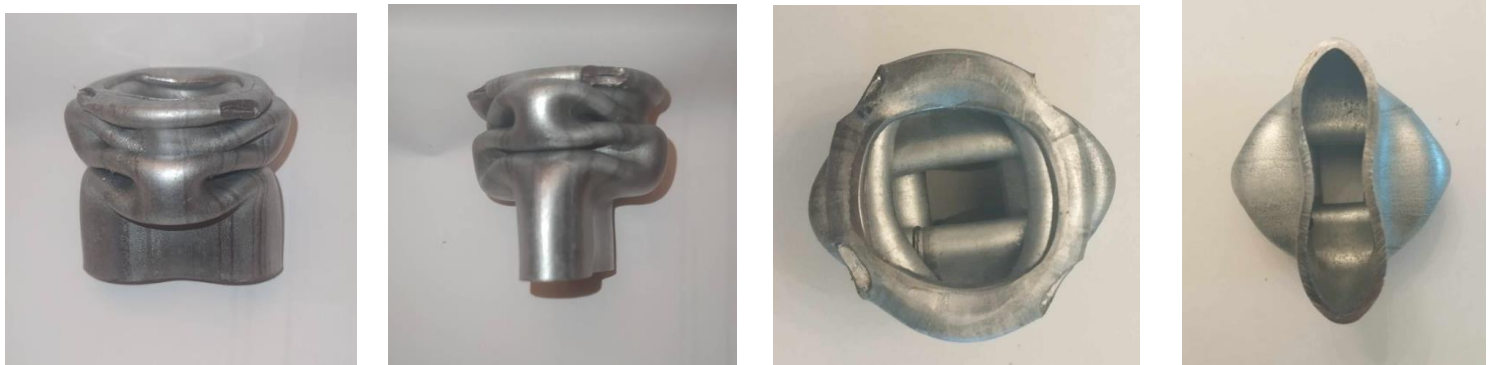
Εικόνα 23 : Δοκίμια μετά την ολοκλήρωση της θλίψης.
