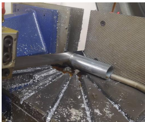
Εικόνα 6: Μέγγενη για σταθεροποίηση του δοκιμίου, παλινδρομική κίνηση σιδεροπρίονου.
