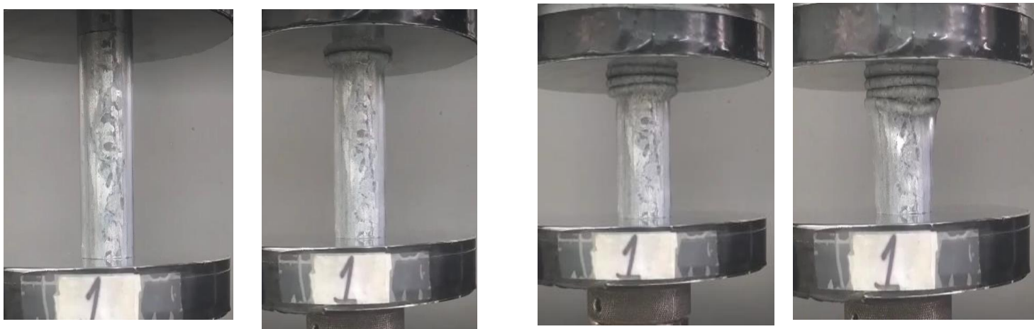
Εικόνα 14: Στιγμιότυπα από διαφορετικές θέσεις κατά την συμπίεση του δοκιμίου .(0 mm,15mm ,30mm, 45mm).
