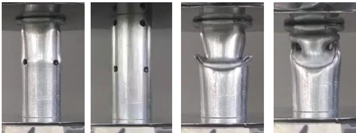
Εικόνα 32: Στιγμιότυπα από διαφορετικές θέσεις κατά την συμπίεση του δοκιμίου. (0 mm, 15mm, 30mm, 45mm).
