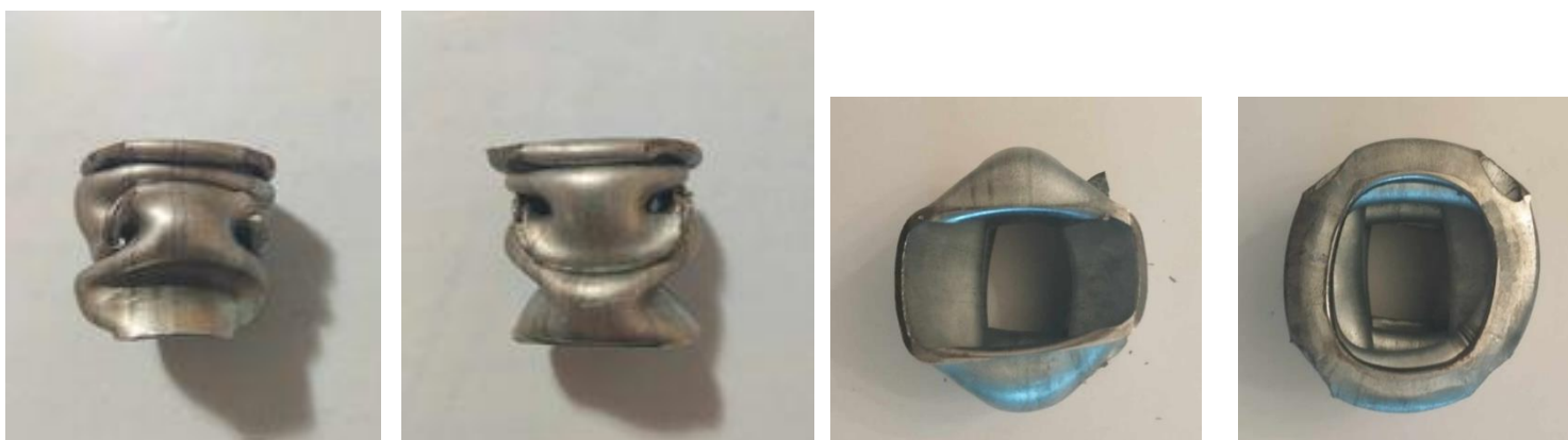
Εικόνα 33: Δοκίμιο μετά την ολοκλήρωση της θλίψης
