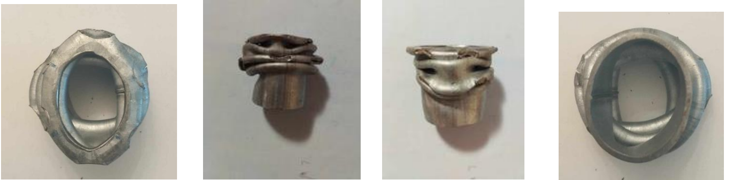
Εικόνα 37: Δοκίμια μετά την ολοκλήρωση της θλίψης
