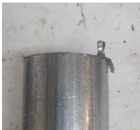
Εικόνα 7: Απομινάρια/απόβλητα υλικού κατά την αρχική κοπή των δοκιμίων.
