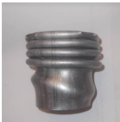
Εικόνα 21: Δοκίμια μετά την ολοκλήρωση της θλίψης.
