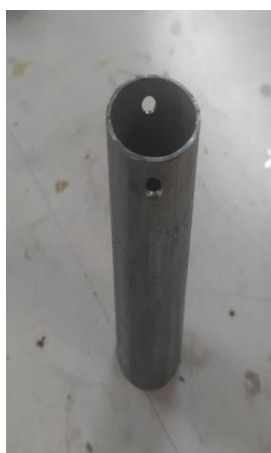
Εικόνα 10: Τελική διαμόρφωση των δοκιμίων για την μελέτη της αξονικής συμπίεσης τους
