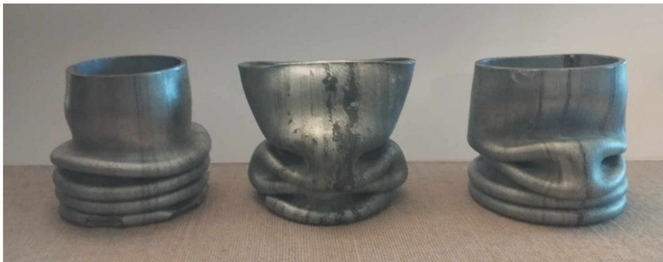
Εικόνα 3: Δοκίμια 1,2,3 που απεικονίζουν εκτατό, μη εκτατό και ανάμεικτο τρόπο κατάρρευσης των δοκιμίων αντίστοιχα.
