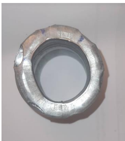
Εικόνα 27: Δοκίμια μετά την ολοκλήρωση της θλίψης
