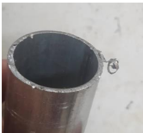
Εικόνα 7: Απομινάρια/απόβλητα υλικού κατά την αρχική κοπή των δοκιμίων.
