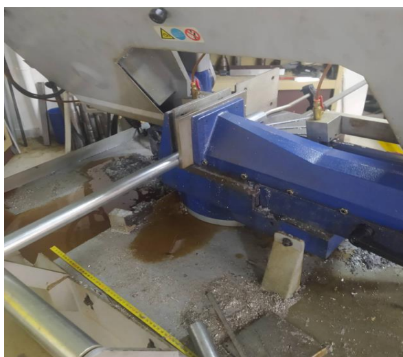
Εικόνα 6: Μέγγενη για σταθεροποίηση του δοκιμίου, παλινδρομική κίνηση σιδεροπρίονου.
