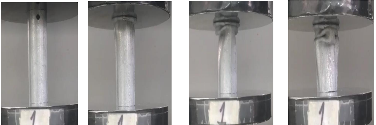
Εικόνα 16: Στιγμιότυπα από διαφορετικές θέσεις κατά την συμπίεση του δοκιμίου .(0 mm,15mm ,30mm, 45mm).
