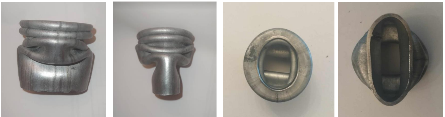
Εικόνα 15 : Δοκίμιο μετά την ολοκλήρωση της θλίψης.
