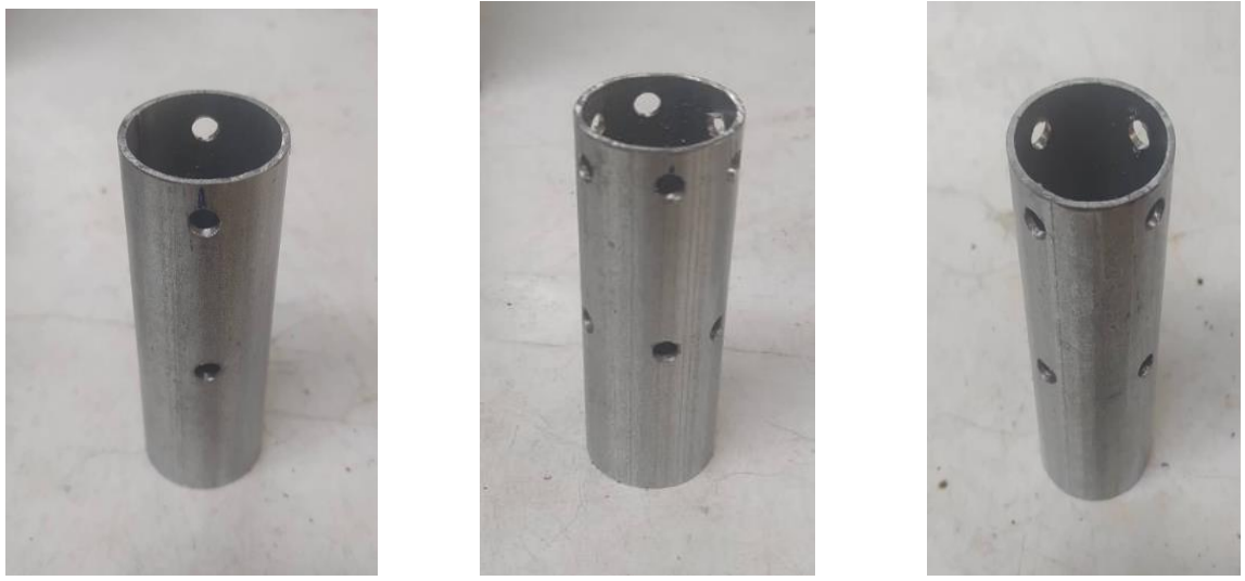
Εικόνα 11: Τελική διαμόρφωση των δοκιμίων για την μελέτη της αξονικής συμπίεσης τους.
