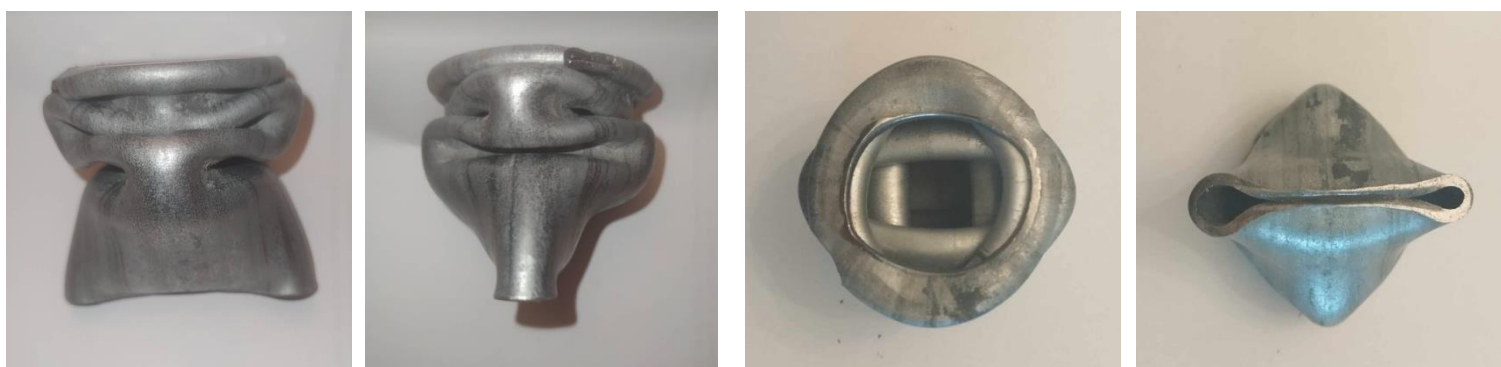
Εικόνα 19: Δοκίμιο μετά την ολοκλήρωση της θλίψης
