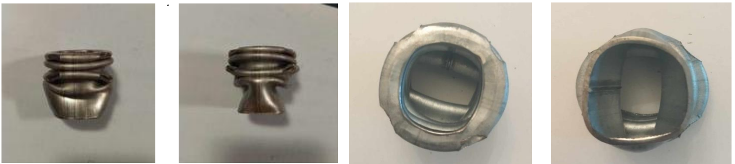
Εικόνα 35: Δοκίμια μετά την ολοκλήρωση της θλίψης
