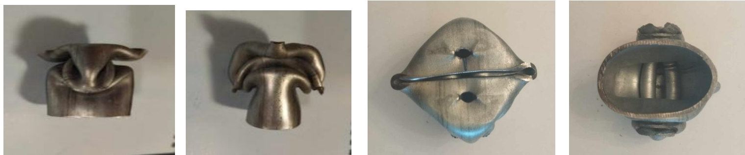
Εικόνα 31: Στιγμιότυπα από διαφορετικές θέσεις κατά την συμπίεση του δοκιμίου. (0 mm, 15mm, 30mm, 45mm).
