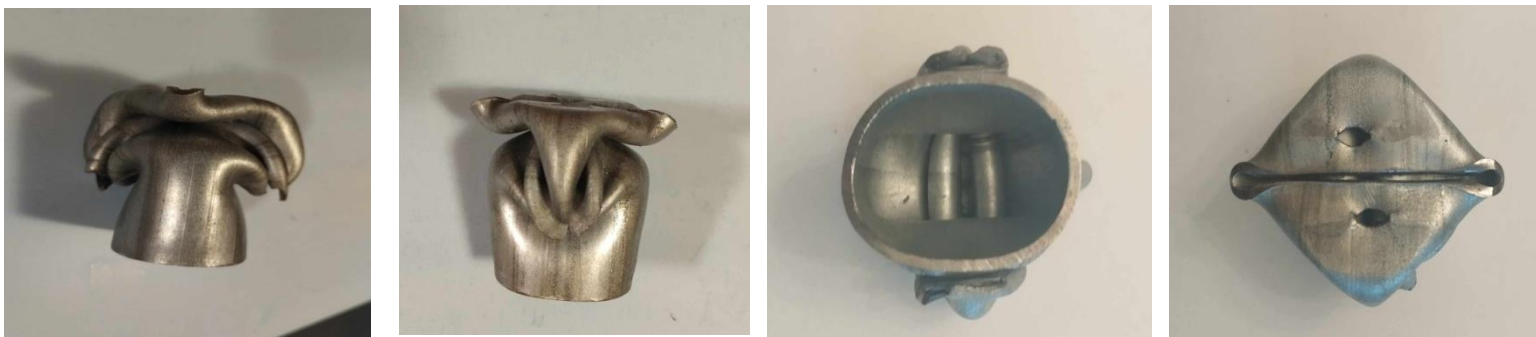
Εικόνα 29: Δοκίμια μετά την ολοκλήρωση της θλίψης.
