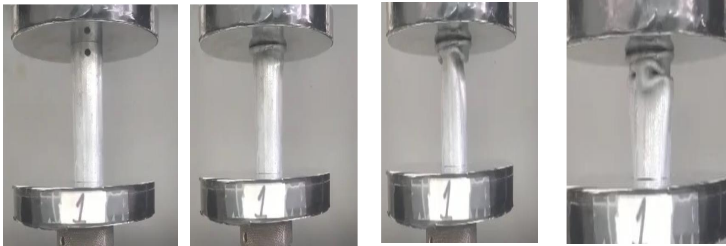
Εικόνα18: Στιγμιότυπα από διαφορετικές θέσεις κατά την συμπίεση του δοκιμίου .(0 mm,15mm ,30mm, 45mm).
