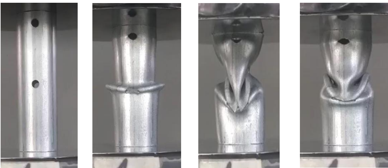
Εικόνα 30: Στιγμιότυπα από διαφορετικές θέσεις κατά την συμπίεση του δοκιμίου (0 mm, 15mm, 30mm, 45mm).
