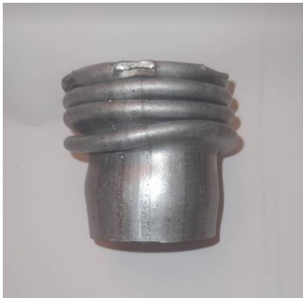
Εικόνα 25: Δοκίμιο μετά την ολοκλήρωση της θλίψης.
