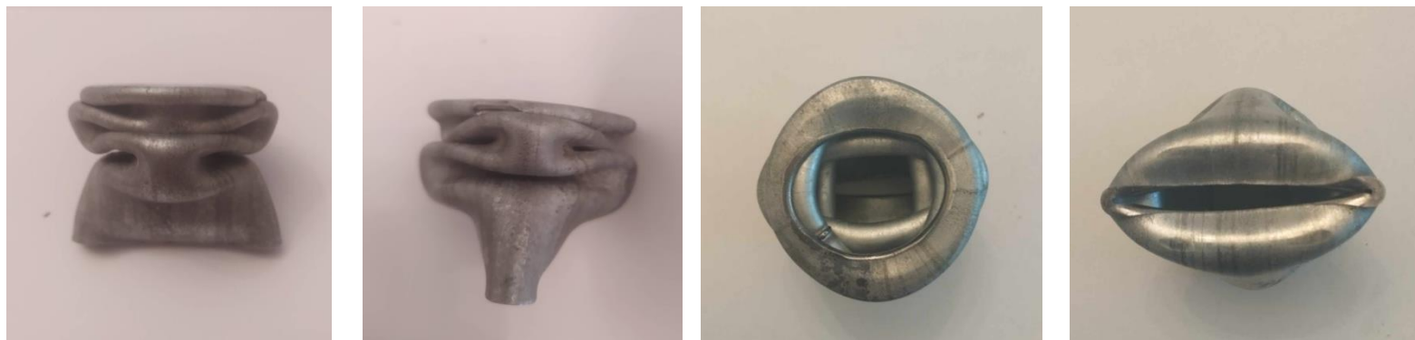
Εικόνα 13: Δοκίμιο μετά την ολοκλήρωση της θλίψης.
