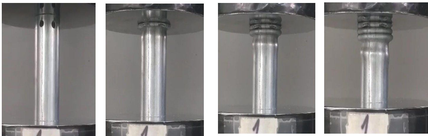
Εικόνα 26: Στιγμιότυπα από διαφορετικές θέσεις κατά την συμπίεση του δοκιμίου (0 mm, 15mm, 30mm, 45mm).
