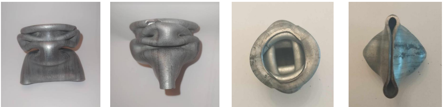
Εικόνα 17 : Δοκίμιο μετά την ολοκλήρωση της θλίψης.
