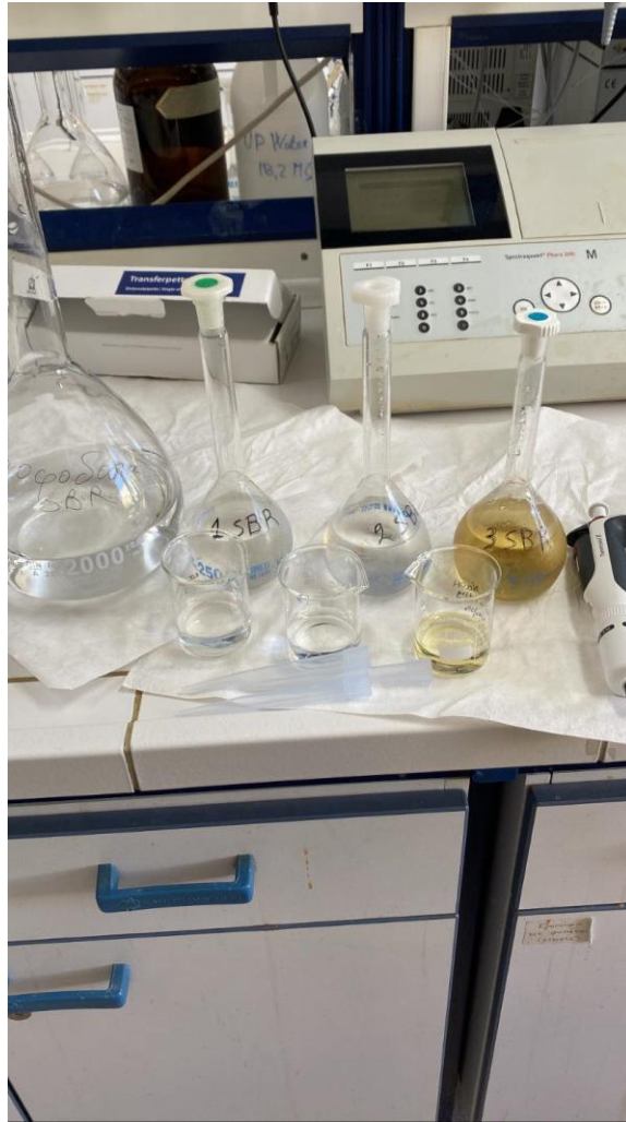
Εικόνα 35 : Τροφοδοσία SBR με τα τρία διαλύματα ιχνοστοιχείων
