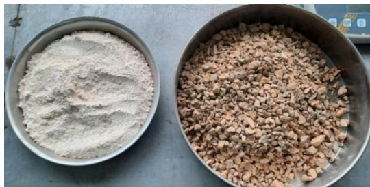
Εικόνα 4.1 Μετακαολίνης (αριστερά) και ανακυκλωμένα αδρανή (δεξιά)
