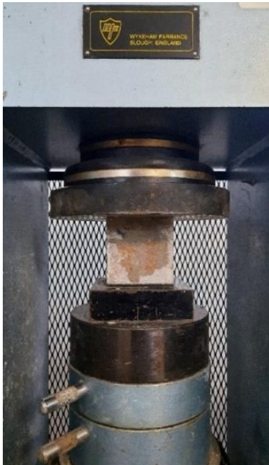
Εικόνα 4.4 Δοκίμιο σκυροδέματος στην πρέσα κατά την διάρκεια της δοκιμής θλίψης
