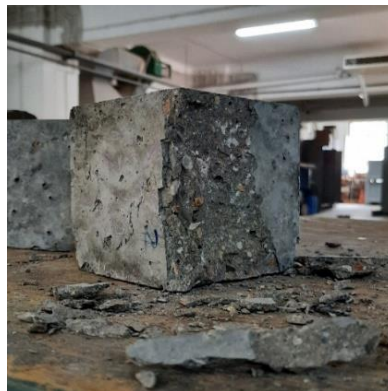
Εικόνα 4.6 Κυβικό δοκίμιο σκυροδέματος σε κατάσταση αστοχίας μετά την δοκιμή θλίψης
