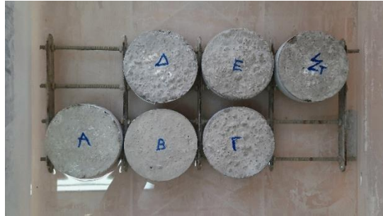
Εικόνα 4.10 Δοκίμια επάνω σε μεταλλική σχάρα κατά την διάρκεια της δοκιμής τριχοειδούς αναρρόφησης
