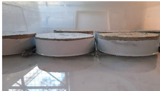
Εικόνα 4.11 Δοκίμια τυλιγμένα πλευρικά με μονωτική ταινία κατά την διάρκεια της δοκιμής τριχοειδούς αναρρόφησης
