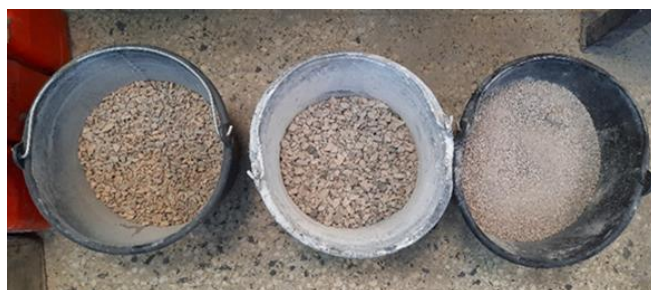
Εικόνα 1.9 Ανακυκλωμένα αδρανή (αριστερά), φυσικά ασβεστολιθικά αδρανή (κέντρο), άμμος (δεξιά)
