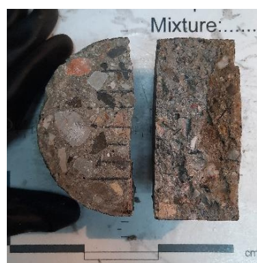
Εικόνα 4.15 Μέτρηση με χάρακα και καταγραφή του βάθους διείσδυσης χλωριόντων στο δοκίμιο σκυροδέματος
