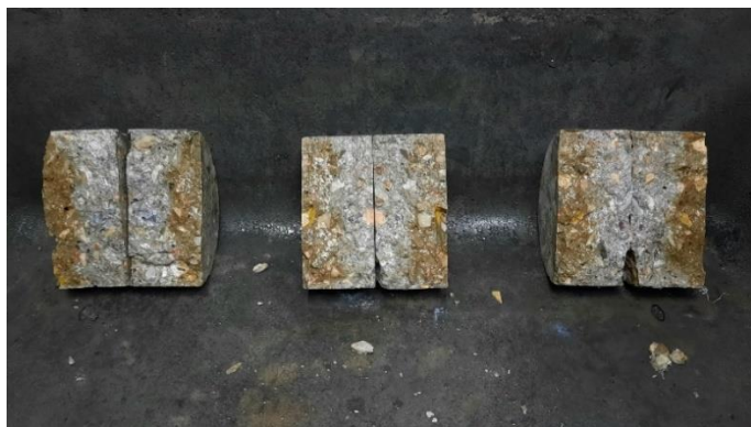
Εικόνα 4.16 Δοκίμια μετά την διάρρηξή τους και τον ψεκασμό τους με διάλυμα νιτρικού αργύρου ( \text{AgNO}_3 ) 0.1 M κατά την διαδικασία της χρωματογραφικής μεθόδου προσδιορισμού του βάθους διείσδυσης χλωριόντων. Η ανοιχτόχρωμη επιφάνεια απεικονίζει το βάθος διείσδυσης.
