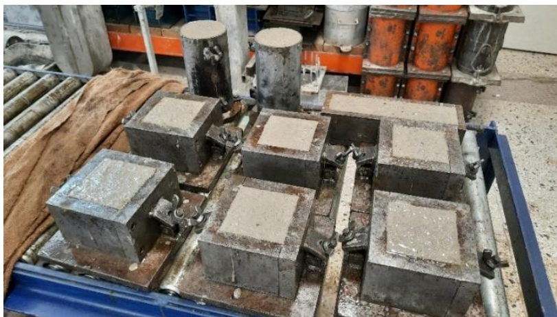
Εικόνα 4.3 Χαλύβδινες μήτρες δοκιμίων σκυροδέματος πληρωμένες με νωπό σκυροδέμα
