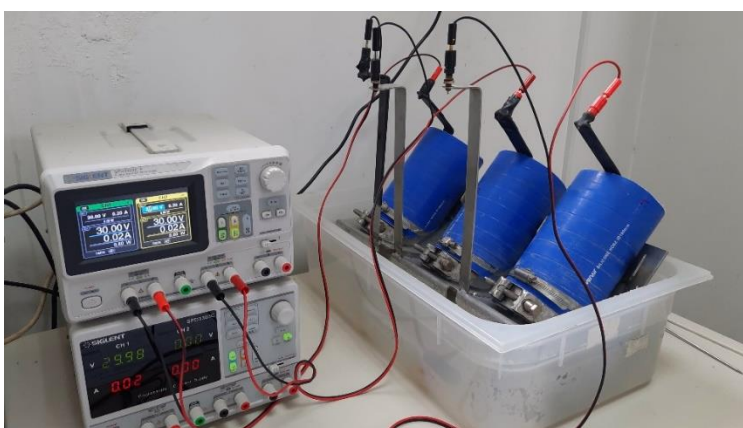
Εικόνα 4.13 Δεξιά οι σωλήνες με τα δοκίμια που βρίσκονται πάνω σε μεταλλικές βάσεις μέσα στην λεκάνη με το αλατόνερο, και αριστερά το τροφοδοτικό που συνδέεται με ηλεκτρόδια με τα άκρα των μεταλλικών βάσεων
