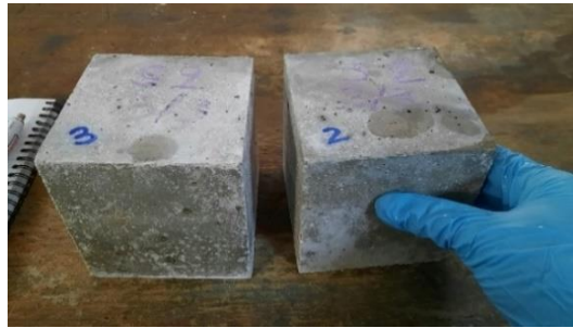
Εικόνα 4.5 Κυβικά δοκίμια σκυροδέματος πριν την δοκιμή θλίψης
