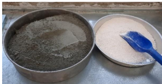
Εικόνα 4.2 Τσιμέντο Portland CEM I 42,5 N (αριστερά) και μετακαολίνης (δεξιά)
