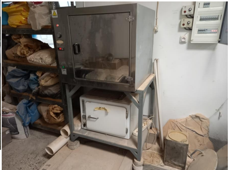
Σχήμα 23: Πειραματικός εξοπλισμός προσδιορισμού ανοιχτού πορώδους (α) Ζύγιση υπό αιώρηση (β) Φούρνος ξήρανσης
