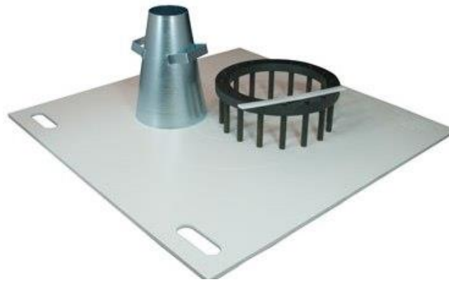
Σχήμα 10: Απεικόνιση δοκιμής δακτυλίου J [πηγή: www.atlanticsupply.com ]
