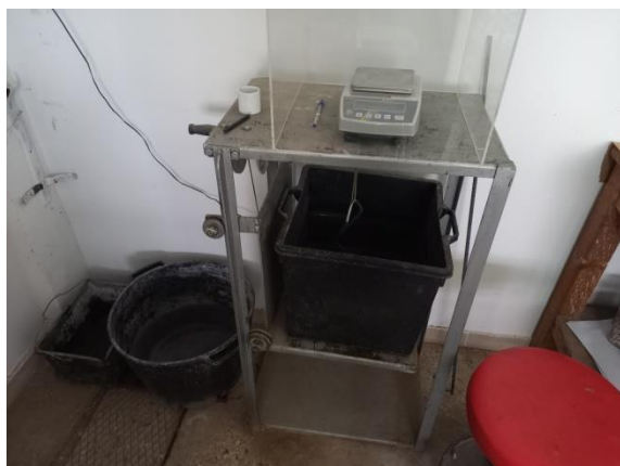
Σχήμα 27: Εξοπλισμός πειράματος κύκλου υγρού-ξηρού
