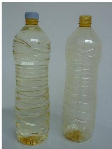
Εικόνα 3: Οι πρώτες φιάλες από PEF που κατασκευάστηκαν (αριστερά) και τυπικές διαφανείς φιάλες από PET που κατασκευάζονται σήμερα (δεξιά) [6]
