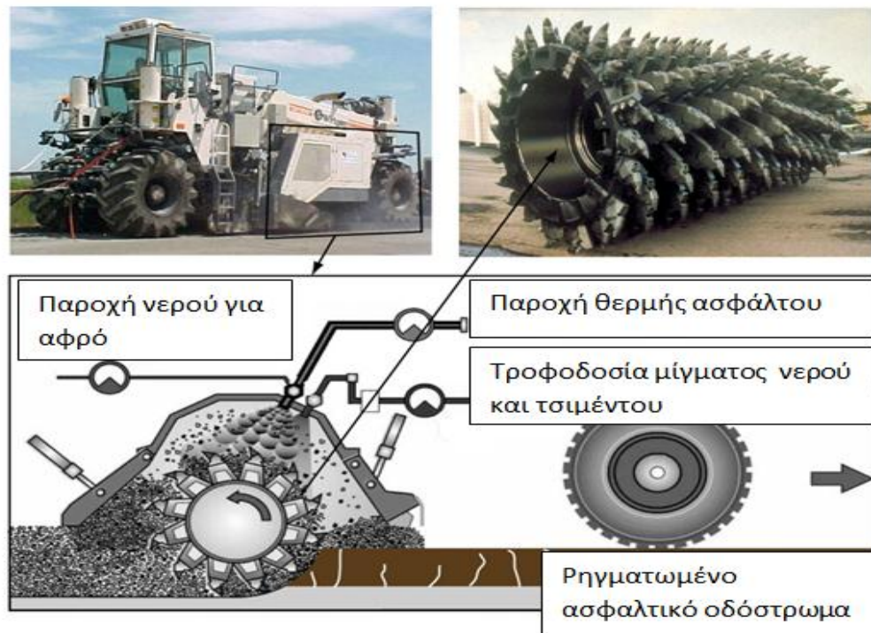
Εικόνα 4.2 Επί τόπου ψυχρή ανακύκλωση εις βάθος με αφρώδη άσφαλτο
