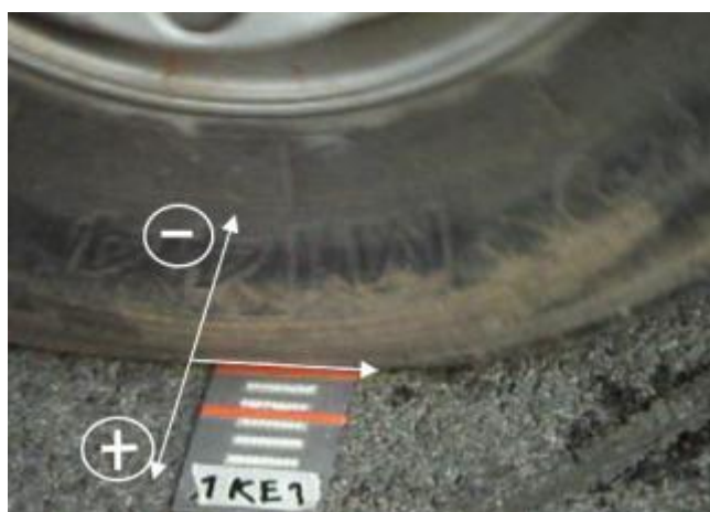
Εικόνα 5.4 Ακριβής εντοπισμός ίχνους τροχού
