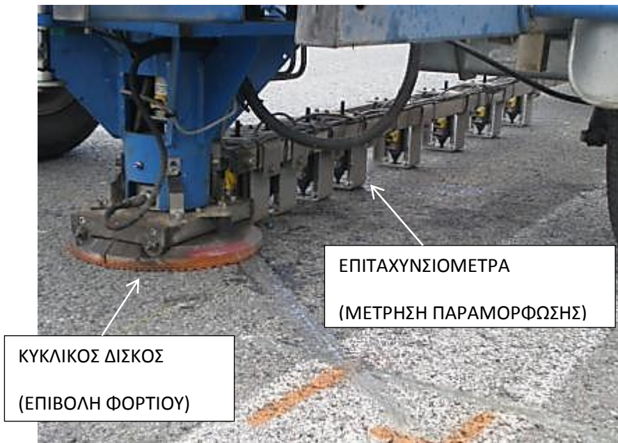
Εικόνα 2.9 Παραμορφωσιμόμετρο Πίπτοντος Βάρους (FWD)
