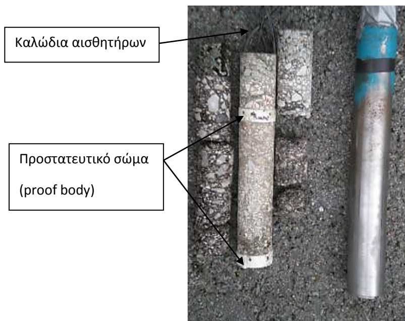
Εικόνα 4.6 Πυρήνας με αισθητήρες οπτικών ινών μέσα σε προστατευτικό σώμα
