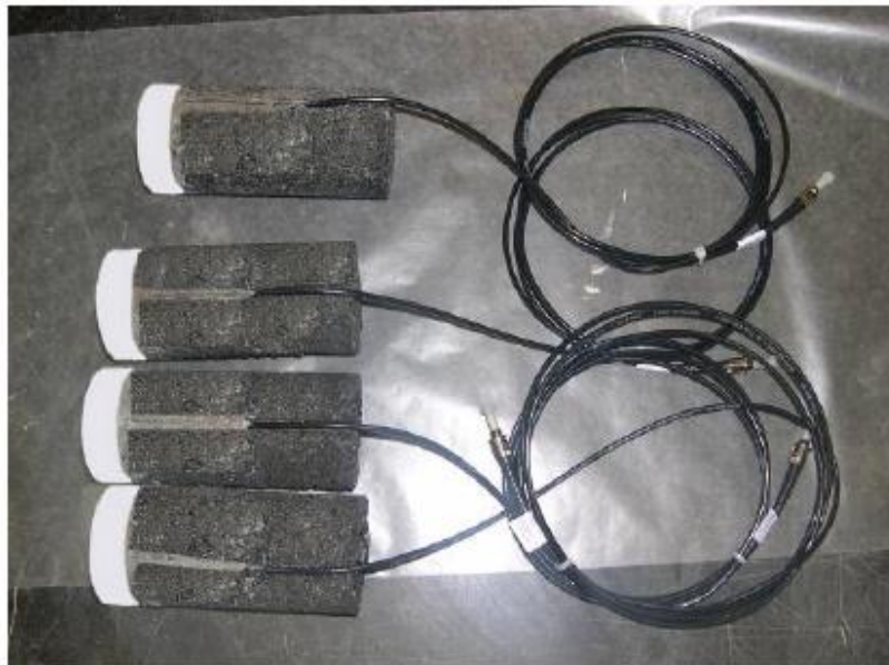
Εικόνα 3.9 Μετρητές παραμόρφωσης έτοιμοι για εγκατάσταση στη στρώση ασφαλτικού σκυροδέματος
