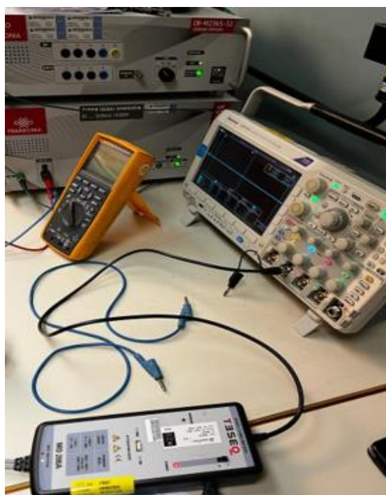
Εικόνα 30. AC Voltage /V μέτρηση με τη χρήση πολυμέτρου και καταμεριστή τάσης
