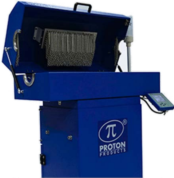
Εικόνα 2.17: Συσκευή για δοκιμή διηλεκτρικής αντοχής μανδύων καλωδίων περιέχουσα bead chain electrode [44].
