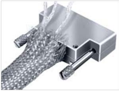
Βήμα 1 ο : Προετοιμασία των θωρακίσεων (για να καταλήγουν κυκλικά στο backshell).
