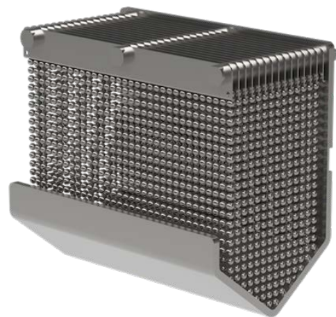
Εικόνα 2.16: Bead Chain Electrode για δοκιμή διηλεκτρικής αντοχής σε μονωτικούς μανδύες καλωδίων [43].
