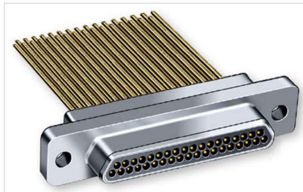
Εικόνα 3.9: Εμπρός όψη αρσενικού συνδέσμου με ελεύθερους αγωγούς (Micro-D MWDM Metal Shell Uninsulated Wire Connector). Μπροστά διακρίνονται οι μεταλλικές ακίδες των αρσενικών επαφών που εισέρχονται στις μεταλλικές οπές των θηλυκών επαφών. [40].
