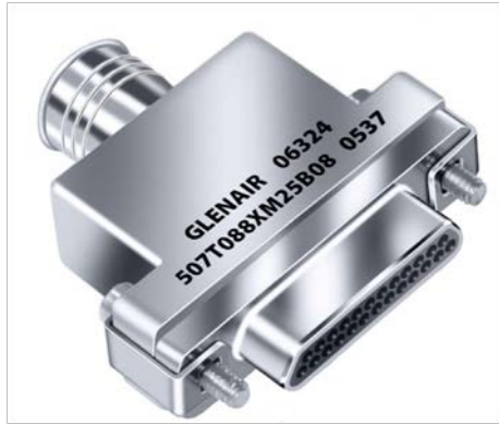
Εικόνα 5.2: Το Backshell τύπου 507T088, Top Entry, Composite EMI/RFI Banding Backshell, Round Cable Entry [40].
