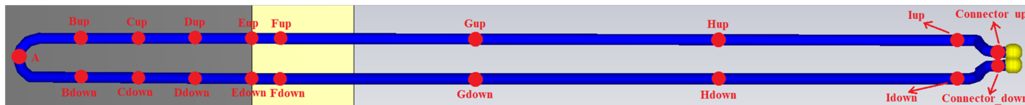
Σχήμα 6.7: Τα σημεία λήψης μετρήσεων από το Πείραμα Εμμέσου ESD στο Καλώδιο SpW των 10 m [56, με επεξεργασία στο Paint].
