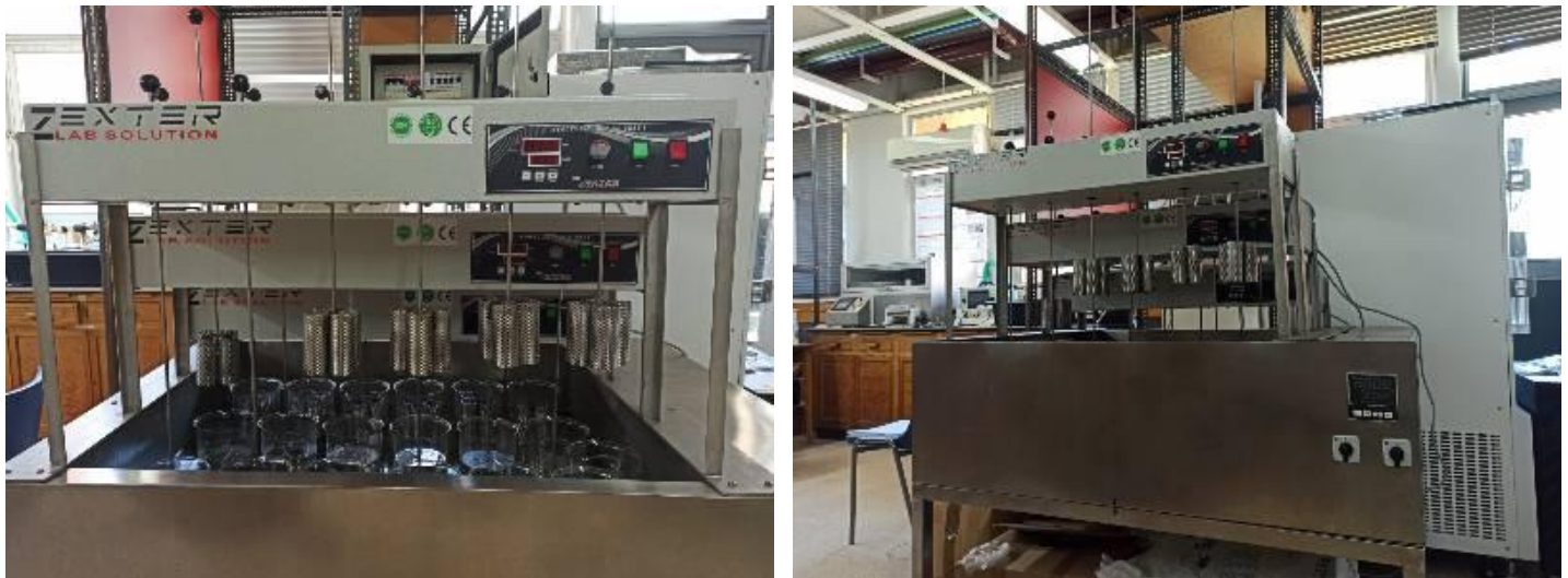
Εικόνα 10: Το μηχανήμα ωσμωτικής αφυδάτωσης το οποίο χρησιμοποιήθηκε για τη διεξαγωγή των πειραμάτων. Στις φωτογραφίες διαφαίνονται οι αναδευτήρες με εφαρμοσμένες τις διάτρητες θήκες στα πτερύγια τους, τα ποτήρια ζέσεως γεμισμένα με ωσμωτικό διάλυμα, το υδατόλουτρο και ο πίνακας ρύθμισης της θερμοκρασίας και της ταχύτητας ανάδευσης.
