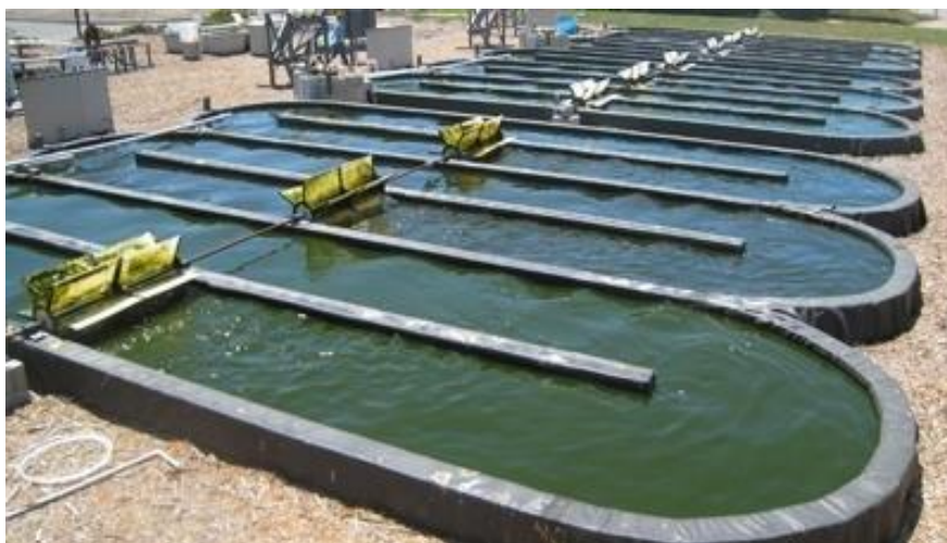
Εικόνα 4: Παράδειγμα ανοικτού συστήματος καλλιέργειας μικροφυκών - Φωτοαντιδραστήρας ανοικτής διαδρομής (open raceway photobioreactor)
