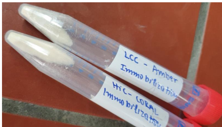
Εικόνα 5.3 Τελική μορφή βιοκαταλυτών μέσα σε falcons μετά και το τέλος της λυοφιλίωσης.
