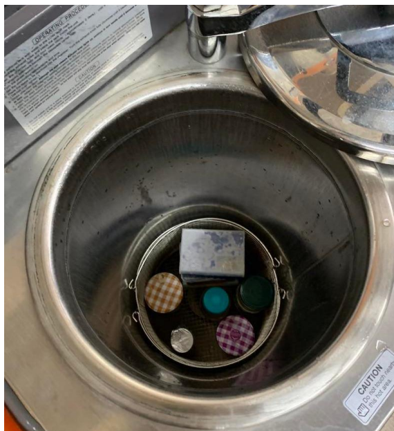
Εικόνα 4.1 Αυτόκαυστο αποστείρωσης όπου αποστειρώνεται το θρεπτικό υλικό και τα απαραίτητα σκεύη για την πειραματική διαδικασία του γενετικού ανασυνδυασμού.
