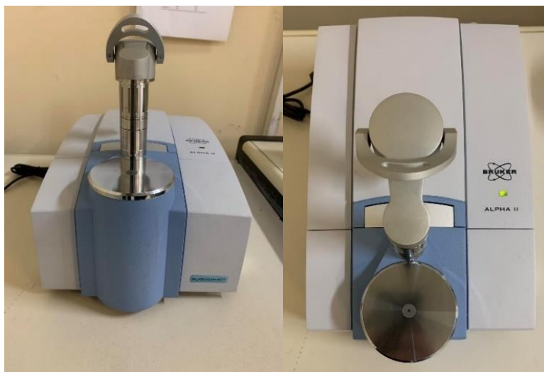
Εικόνα 4.20 Όργανο Platinum-ATR ALFA II Bruker.
