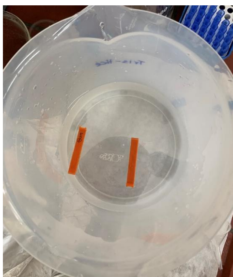
Εικόνα 4.11 Δοχείο στο οποίο πραγματοποιήθηκε η διαπίδυση. Στο δοχείο περιέχεται η μεμβράνη με τα κλάσματα HiC 100A και HiC 100B που προέκυψαν από τη χρωματογραφία συγγένειας καθώς και το ρυθμιστικό διάλυμα Tris-HCl 20 mM.
