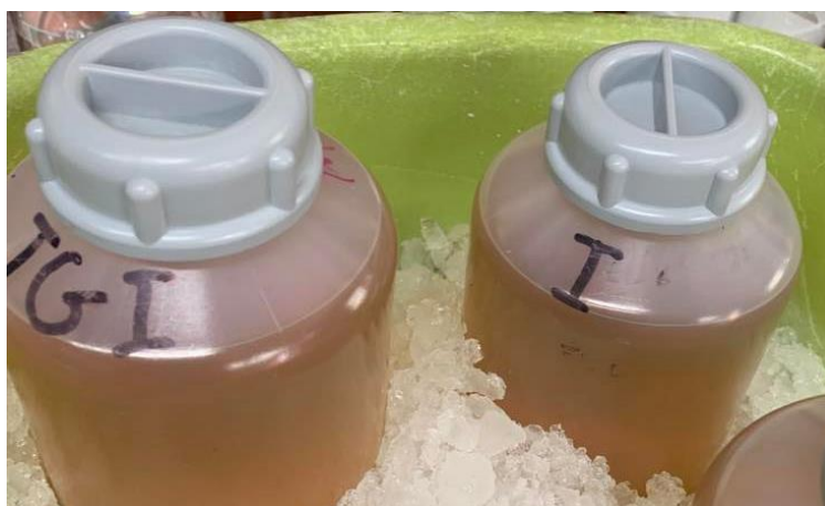
Εικόνα 4.6 Φιάλες φυγοκέντρησης με το περιεχόμενο των υγρών καλλιεργειών τοποθετημένες μέσα σε δοχείο με πάγο προς προστασία των εκφρασμένων ενζύμων.
