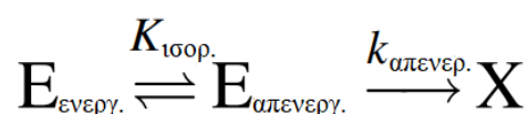
Εικόνα 4.13 Μοντέλο ισορροπίας για την επίδραση της θερμοκρασίας στην ενεργότητα του ενζύμου, όπου E_{ενεργ.} είναι η ενεργή μορφή του ενζύμου, E_{απενεργ.} είναι η απενεργοποιημένη του μορφή και X είναι η μετουσιωμένη του μορφή [9].
