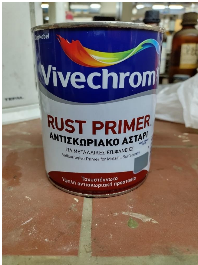
Εικόνα 5.5-α Αντιδιαβρωτικό επικαλυπτικό με αλκυδικές ρητίνες που χρησιμοποιήθηκε (Rust Primer της Vivechrom)
