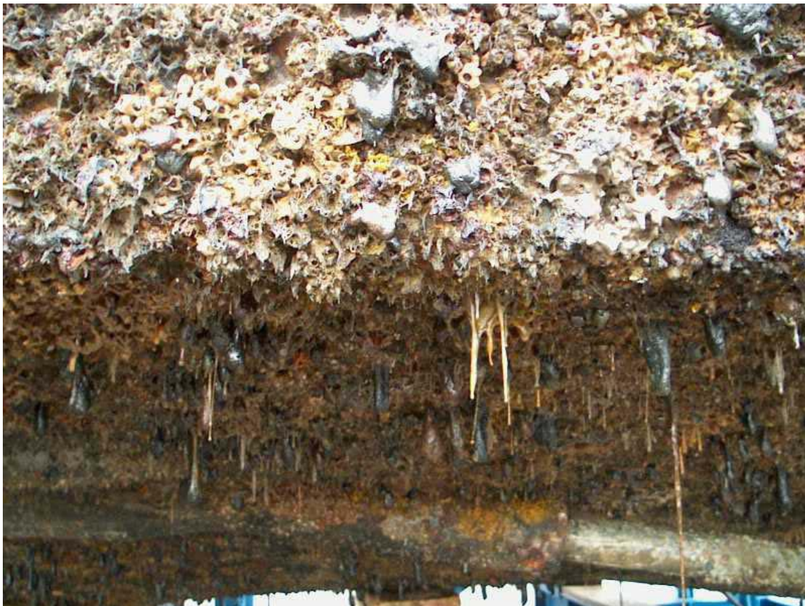
Εικόνα 2.4.5.3-δ : Έντονη δημιουργία αποθέσεων στη γάστρα
