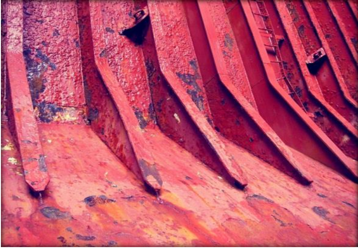
Εικόνα 1.4.2-α : Διάβρωση με βελονισμούς
