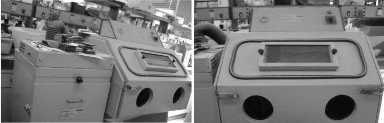
Εικόνες 5.4 -α & β : Εγκατάσταση Ψηματοβολής
