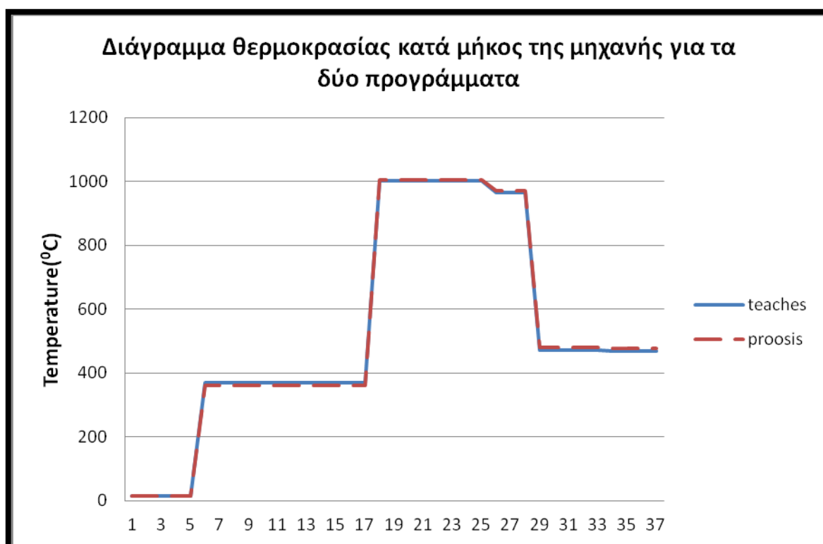
Σχήμα 5.13: Διάγραμμα θερμοκρασίας κατά μήκος του κινητήρα Tornado για τα δύο προγράμματα TEACHES και PROOSIS με βάση την αρίθμηση της σχηματικής δομής βιομηχανικών αεροστροβίλων του λογισμικού TEACHES.
