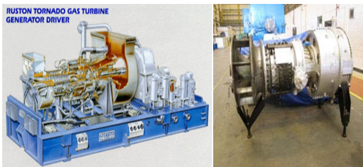
Σχήμα 4.1: Σχηματική διάταξη και εξωτερική όψη αεριοστροβίλου Tornado
