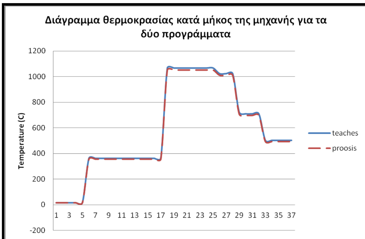
Σχήμα 5.18: Διάγραμμα θερμοκρασίας κατά μήκος του κινητήρα ABB GT10 για τα δύο προγράμματα TEACHES και PROOSIS με βάση την αριθμηση της σχηματικής δομής βιομηχανικών αεριοστροβίλων του λογισμικού TEACHES.
