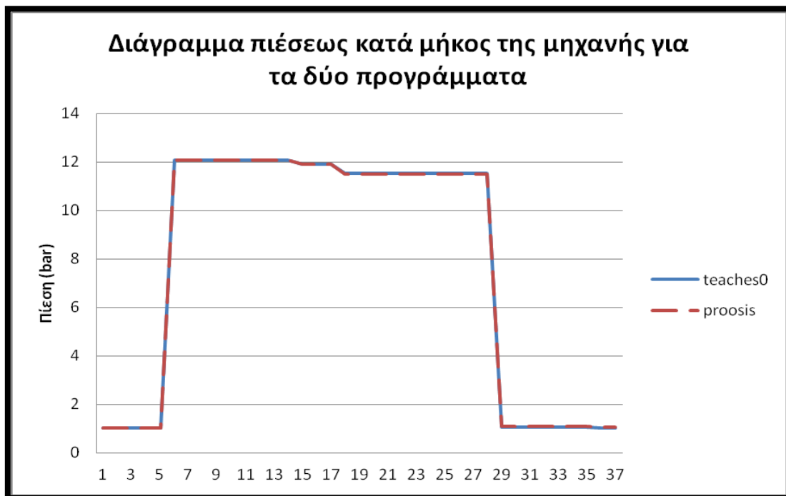
Σχήμα 4.6: Διάγραμμα πίεσεως κατά μήκος του κινητήρα Tornado για τα δύο προγράμματα TEACHES και PROOSIS με βάση την αριθμηση της σχηματικής δομής βιομηχανικών αεριοστροβίλων του λογισμικού TEACHES.
