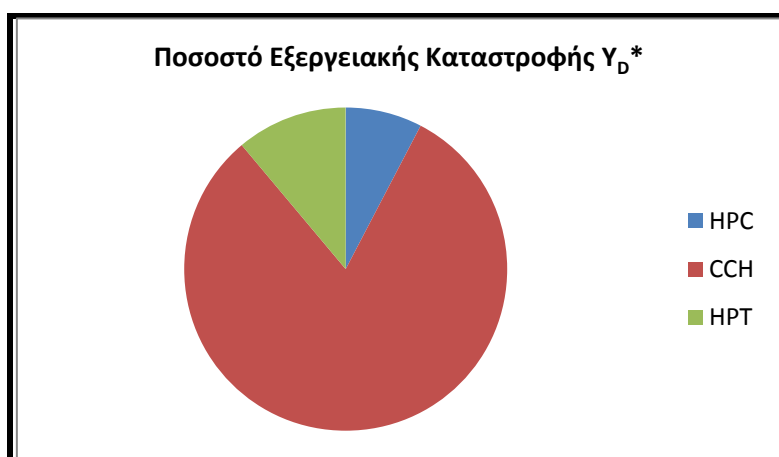
Σχήμα 7.4: Διάγραμμα ποσοστού εξεργειακής καταστροφής Y_D^*
