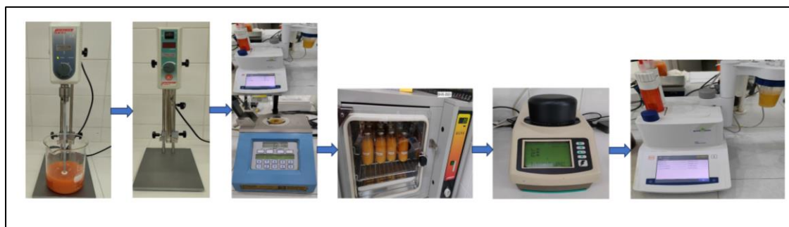
Εικόνα 22. Τα μίγματα ομογενοποιήθηκαν, αναλύθηκαν και ακολούθησαν τεχνητή γήρανση και ελέγχθηκαν ως προς την μεταβολή του χρώματος
