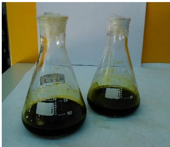
Εικόνα 15. Εκχυλίσματα του διάτομου Phaeodactylum tricornutum μέσω εκχύλισης με μικροκύματα και υπερήχους
