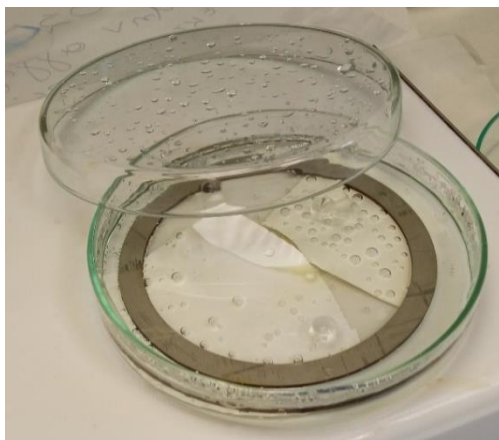
Εικόνα 4.5. Βύθιση των υποστρωμάτων σε δοχείο με διάλυμα PDMS. Το μεταλλικό δαχτυλίδι συγκρατεί στον πυθμένα τα φύλλα μεμβράνης.
