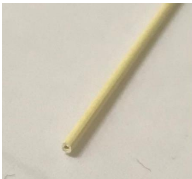
Εικόνα 4.6.(αριστερά) Κοίλη ίνα πολυιμιδίου. Στην περίπτωση που προστεθούν GNPs η ίνα έχει γκριζο χρώμα.
