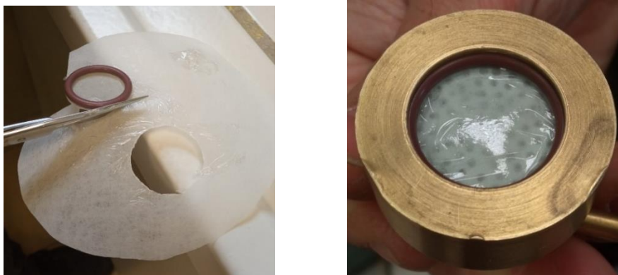
Εικόνα 4.1.α-β. α) Κοπή της μεμβράνης στο σχήμα του o-ring. Πρέπει να δοθεί προσοχή για την ελάχιστη επαφή με τη μεμβράνη, καθώς είναι πολύ ευαίσθητη. β) Μεμβράνη μέσα στο μεταλλικό δομοστοιχείο. Πρέπει να δοθεί προσοχή κατά την ασφάλιση καθώς το περιστρεφόμενο μέρος μπορεί να τσαλακώσει τη μεμβράνη.
