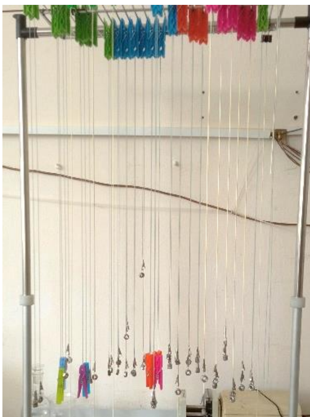
Εικόνα 4.9. Κρεμασμένες ίνες. Χρησιμοποιήθηκαν σιδερένια βαρίδια αντί για μανταλάκια την ώρα της επικάλυψης λόγω του μικρού τους όγκου προς αποτροπή διαφυγής υγρού κατά τη συλλογή του.
