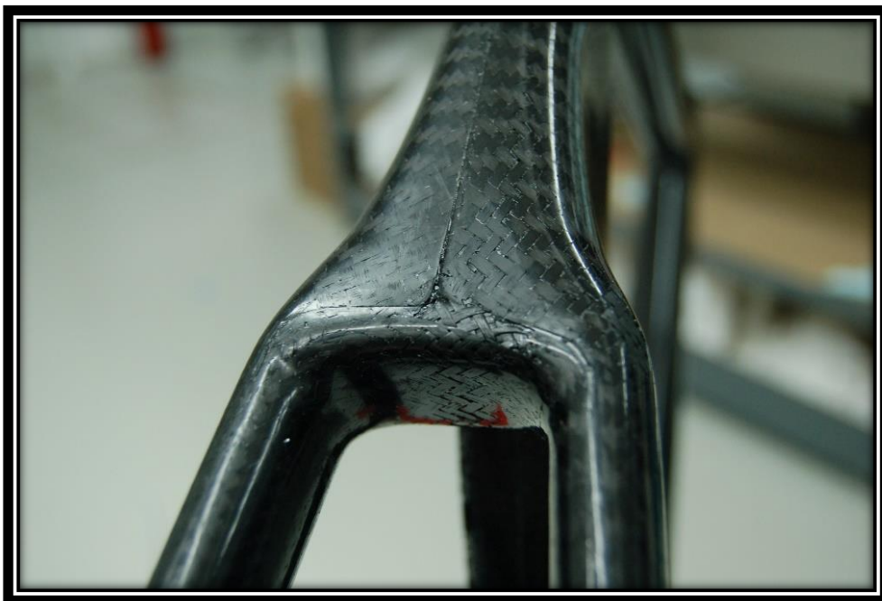
Θ-6.6 Συνδυασμός προβλημάτων από χαμηλή πίεση στις σακούλες και τον τρόπο τοποθέτησής τους εσωτερικά στο σκελετό.
