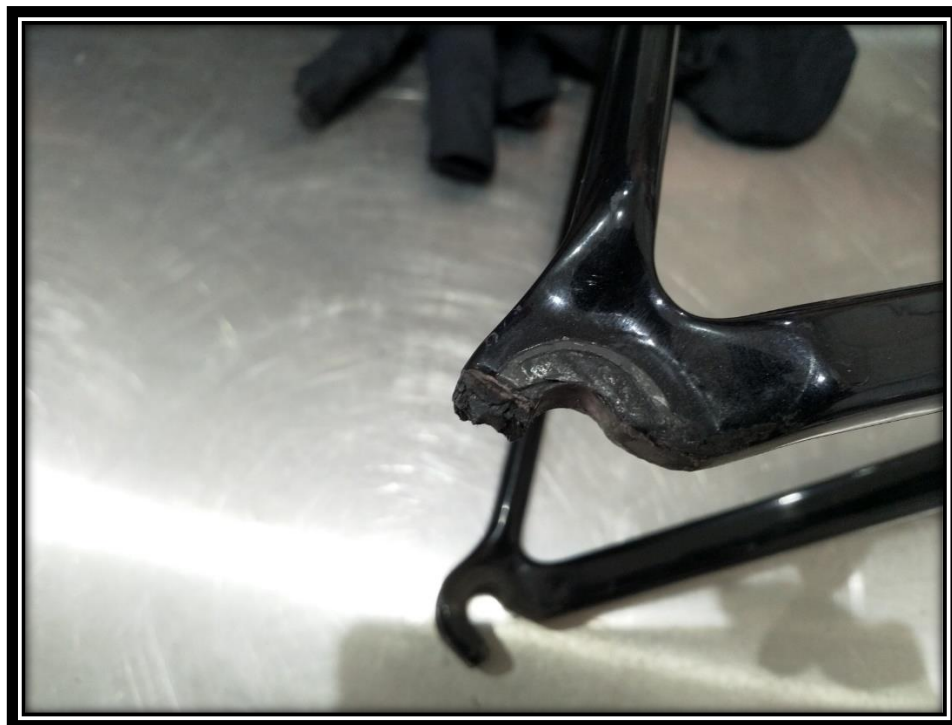
Θ-3.15: Αστοχία στο σημείο ένωσης με τον οπίδιο εκτροχιαστή μετά από αποτυχημένη αλλαγή ταχύτητας όπου μπλόκαρε ο πίσω εκτροχιαστής και έσπασε το νύχι του σκελετού.
