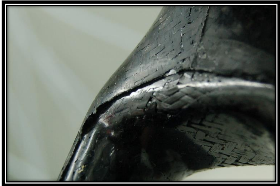
Θ-6.3: Κενό στις στρώσεις επειδή δεν άνοιξαν πλήρως οι σακούλες.
