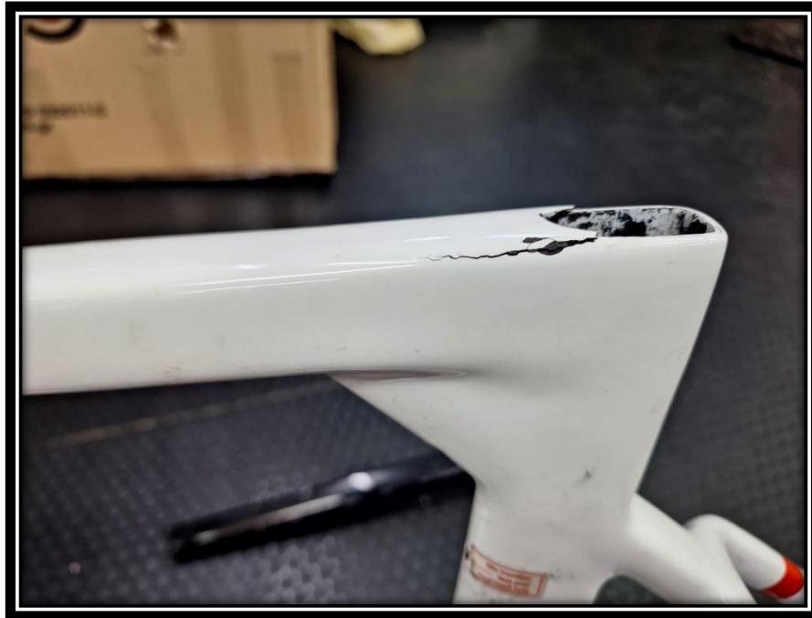
Θ-3.14: Αστοχία στο σημείο ένωσης με το παλουκόσελο που ξεκίνησε από ενδοστρωματική αποκόλληση μετά από πτώση σε λακούβα με τον αναβάτη καθιστό, διαδόθηκε και οδήγησε σε ολική θραύση των ινών.
