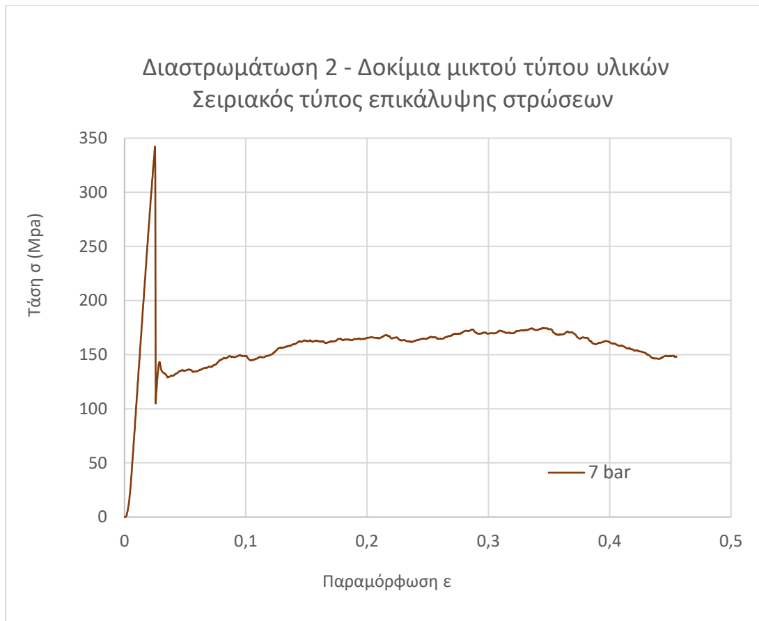
Θ-8.18: Διάγραμμα τάσης – παραμόρφωσης δοκιμίων T700-T300W, με τον κύκλο πολυμερισμού 1 και σειριακό τύπο επικάλυψης.
