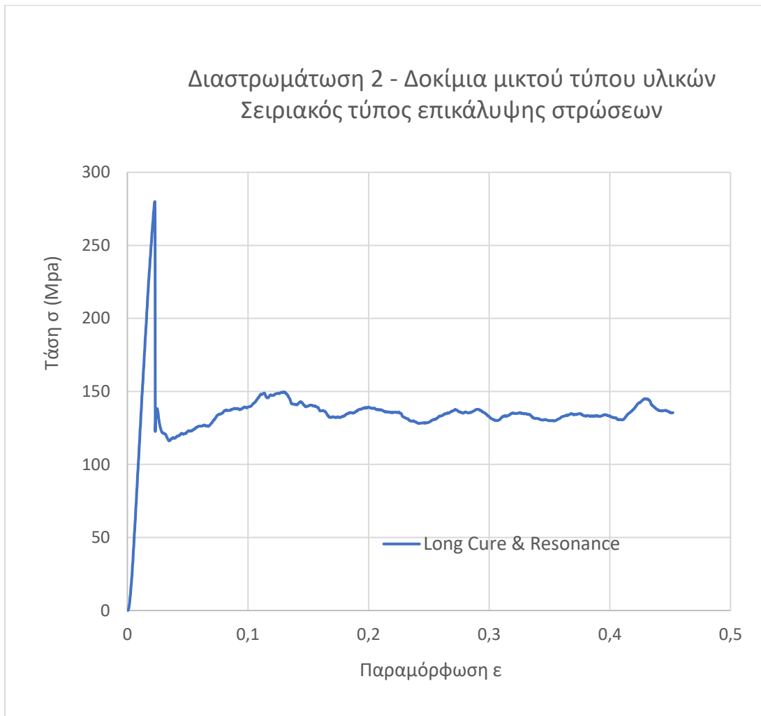
Θ-8.30: Διάγραμμα τάσης – παραμόρφωσης δοκιμίων T700-T300W, με τον κύκλο πολυμερισμού 3 και σειριακό τύπο επικάλυψης.
