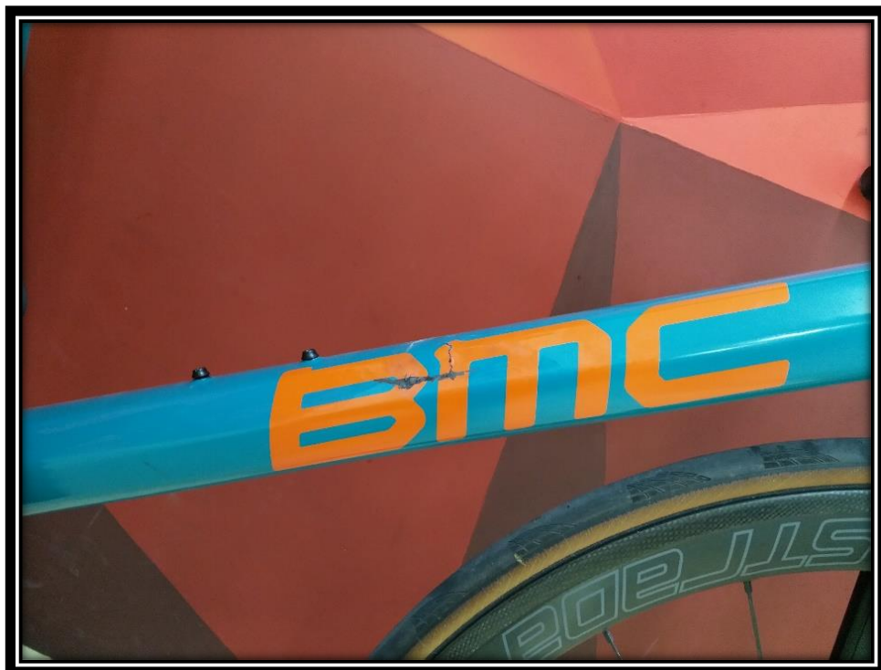
Θ-3.19: Αστοχία από σχάρα μεταφοράς ποδηλάτου.
