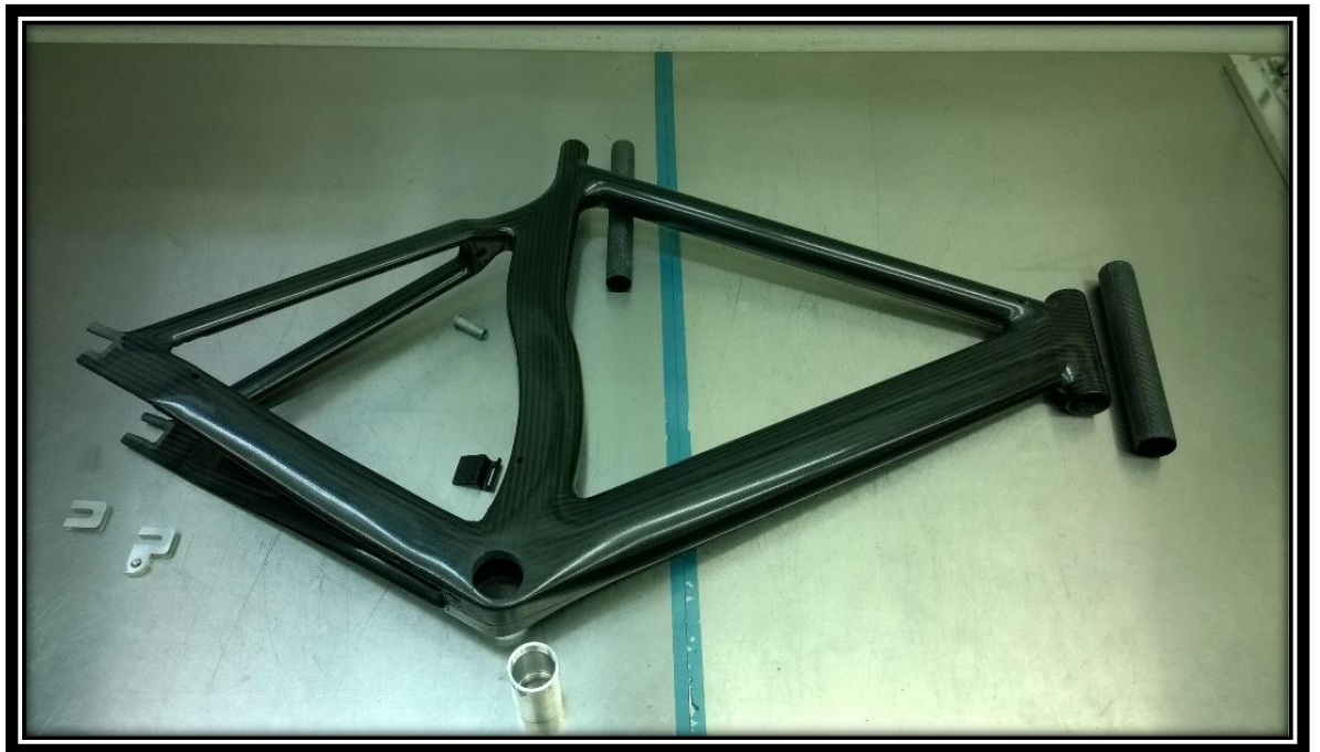
Θ-10.9 Ο σκελετός έτοιμος μετά το φούρνισμα. Διακρίνεται με γυμνό οφθαλμό η εξαιρετική ποιότητα επιφάνειας.
