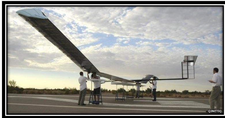
Θ-1.4.2: Zephyr ανθρακονημάτινο αεροσκάφος που κινείται με ηλιακή ενέργεια.
