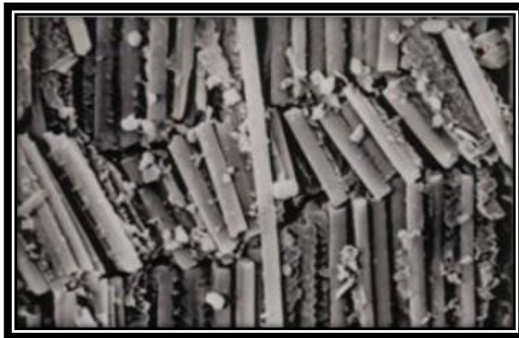
Θ-2.13: Θραύση σε ακανόνιστα σχήματα.
