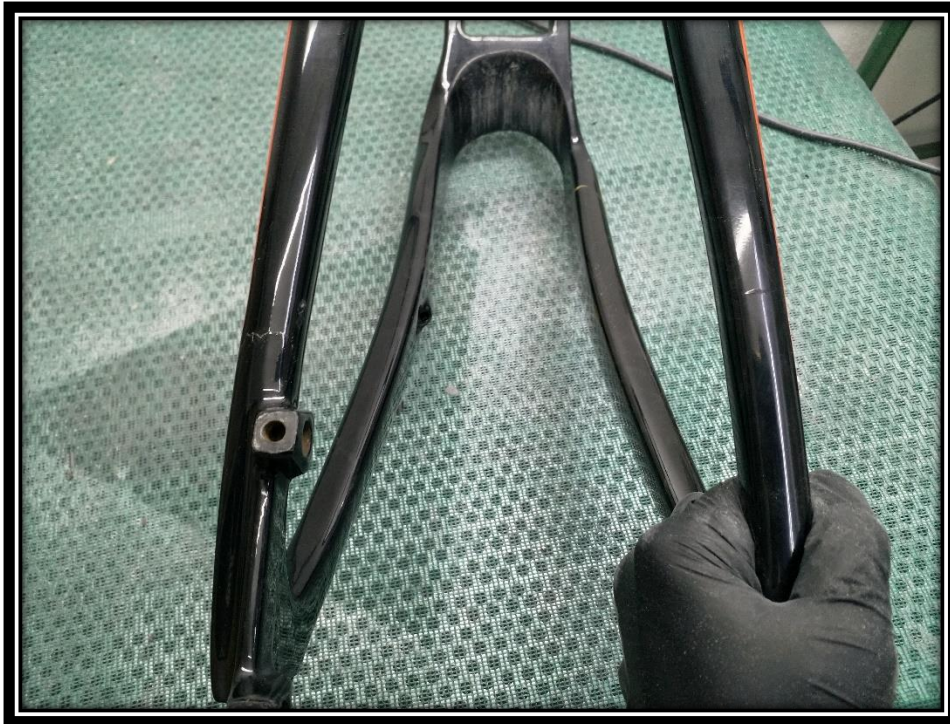
Θ-3.16: Αστοχία από έντονο φρενάρισμα στο σημείο αμέσως μετά τη βάση στήριξης του φρένου.
