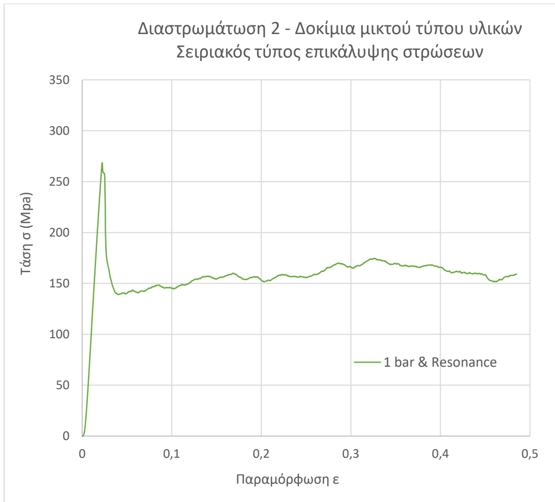
Θ-8.36: Διάγραμμα τάσης – παραμόρφωσης δοκιμίων T700-T300W, με τον κύκλο πολυμερισμού 4 και σειριακό τύπο επικάλυψης.
