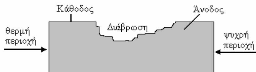
Εικόνα 20: Σχηματική απεικόνιση της θερμογαλβανικής διάβρωσης (47)
