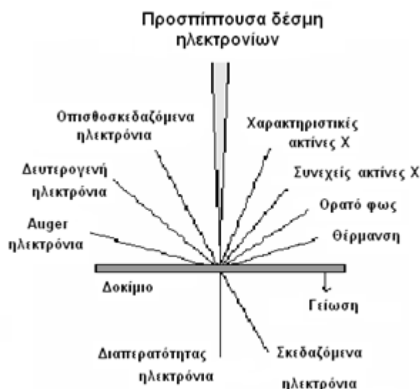
Εικόνα 44: Σχηματική απεικόνιση της λειτουργίας του μικροσκοπίου SEM (179).
