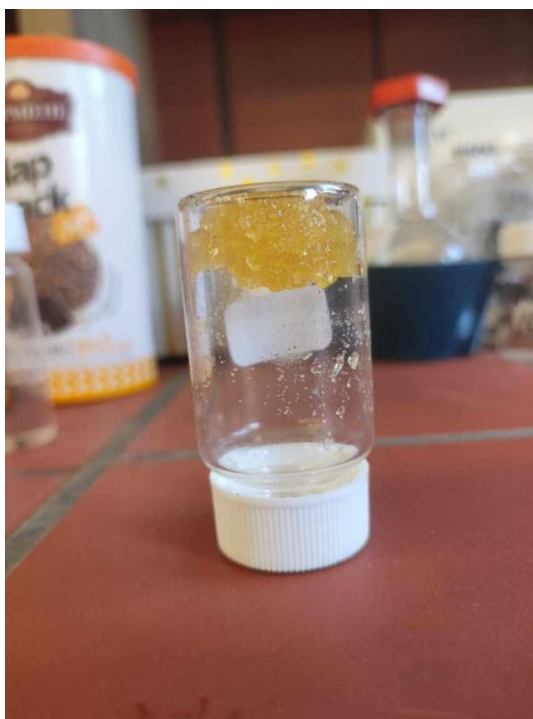
Εικόνα 4.2 Υδρογέλη χιτοζάνης Cs-ChCl:LA-OI πριν την διαδικασία ξήρανης.
