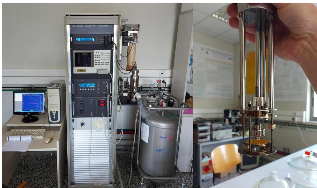
Εικόνα 3.4: Στην αριστερή εικόνα φαίνεται η πειραματική διάταξη DRS (ο H/Y, η συσκευή BDS και η δεξαμενή υγρού αζώτου), στην δεξιά εικόνα η κυψελίδα της συσκευής που εισάγεται το υλικό.
