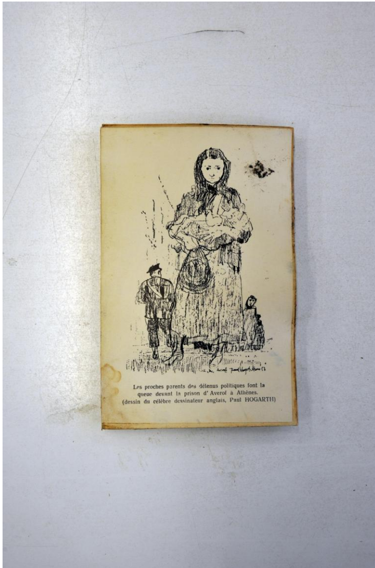
Εικόνα 3.17. Ανάπτυξη μυκήτων στο χαρτί, όταν υπάρξουν οι κατάλληλες συνθήκες(ανάπτυξη πάνω δεξιά και περιφερειακά, μαύρα στίγματα, Αρχείο ΚΚΕ).
