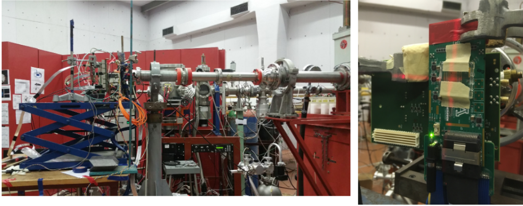
Σχήμα 6: Η διάταξη της δοκιμαστικής δέσμης ακτινοβολίας νετρονίων μαζί με την πλακέτα Mini1 εξοπλισμένη με το VMM3/VMM3a.
