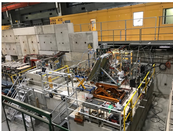
Σχήμα 18: Η γραμμή δέσμης H8 του SPS στην περιοχή Preveessin North του CERN, στην οποία έχει εγκατασταθεί η πειραματική ρύθμιση δοκών δοκιμής Micromegas.
