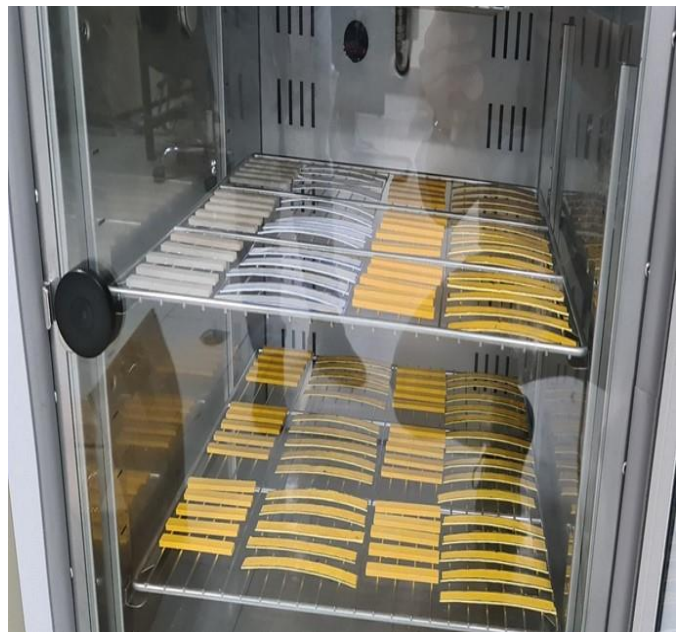
Εικόνα 6.2: Θάλαμος Nüve Climate Chamber TK 120, στον οποίο πραγματοποιήθηκε η φωτο-γήρανση και διάταξη των δοκιμών εντός του θαλάμου.
