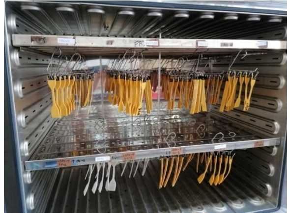
Εικόνα 6.1: Πειραματική διάταξη επιταχυνόμενης θερμικής γήρανσης. Γήρανση υλικών αναφοράς (αριστερά), γήρανση τελικών υποσχομένων συνδυαστικών συστάσεων FRUV (δεξιά).
