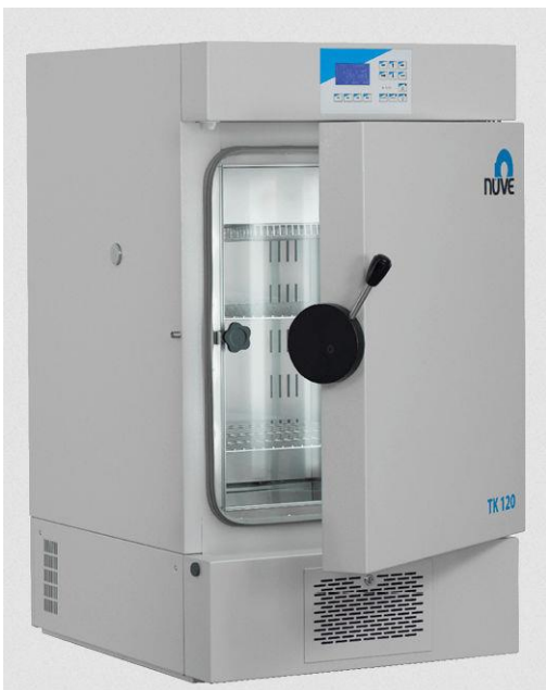
Εικόνα 6.2: Θάλαμος Nüve Climate Chamber TK 120, στον οποίο πραγματοποιήθηκε η φωτο-γήρανση και διάταξη των δοκιμών εντός του θαλάμου.
