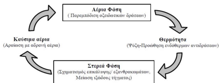
Εικόνα 4.2: Μέθοδοι επιβράδυνσης της καύσης των πολυμερών
