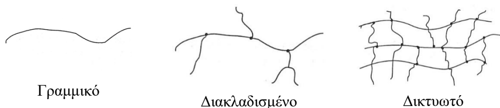
Εικόνα 1.5: Τα είδη των πολυμερών με βάση την αρχιτεκτονική της πολυμερικής αλυσίδας.
