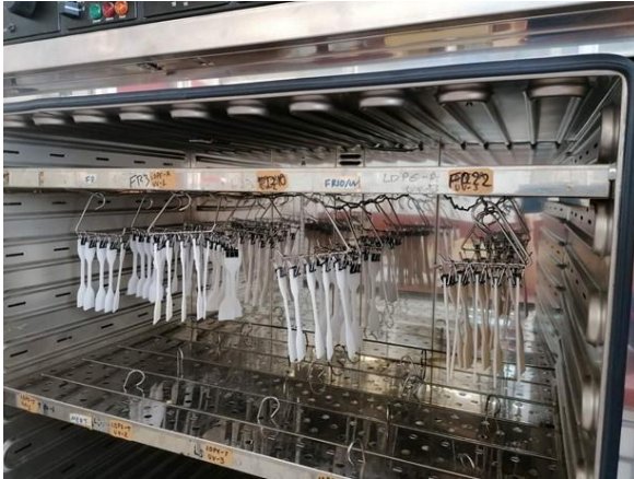
Εικόνα 6.1: Πειραματική διάταξη επιταχυνόμενης θερμικής γήρανσης. Γήρανση υλικών αναφοράς (αριστερά), γήρανση τελικών υποσχομένων συνδυαστικών συστάσεων FRUV (δεξιά).
