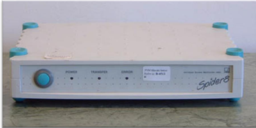
Σχήμα 4.5. Σύστημα συλλογής δεδομένων HBM Spider 8
