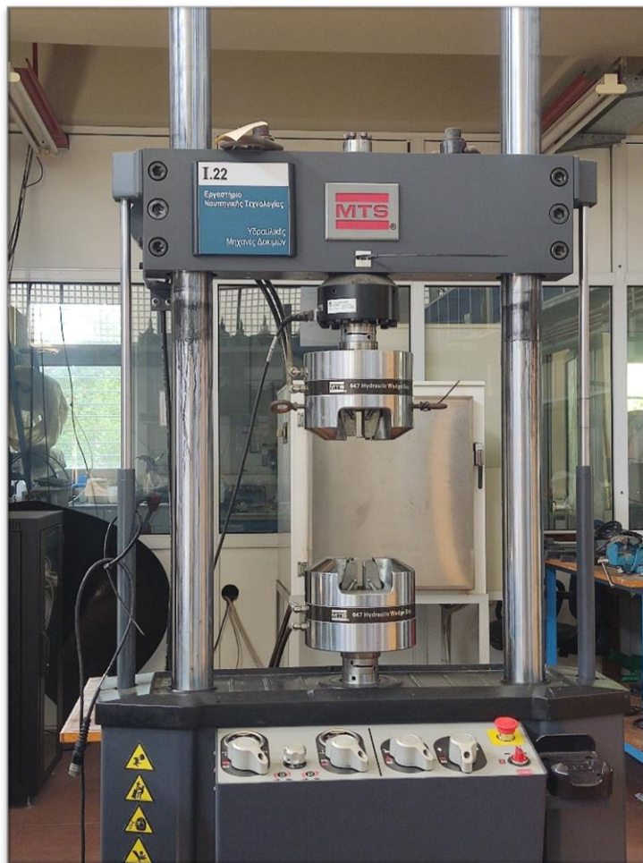
Σχήμα 4.4. Υδραυλική μηχανή MTS 322
