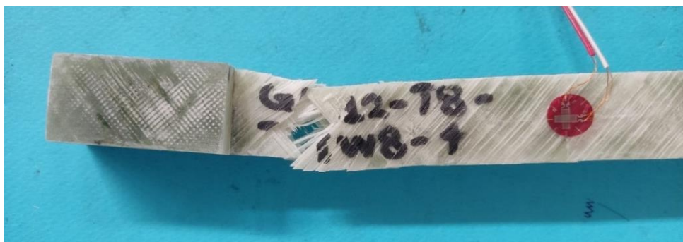
Σχήμα 6.8. Τυπική θραύση δοκιμίου σε δοκιμή διάτμησης με αποχωρισμό των στρώσεων (delamination)
