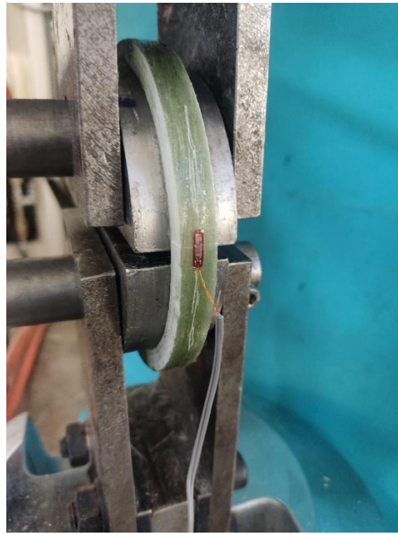
Σχήμα 4.24. Διάταξη με strain gauges και στις 0^\circ - δοκίμιο με εγκοπές (αριστερά) και χωρίς (δεξιά)
