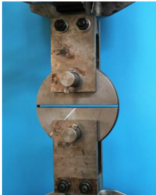
Σχήμα 4.6. Διάταξη διαιρούμενου δίσκου-πείρων-αρπάγων του Εργαστηρίου Ναυπηγικής Τεχνολογίας ΕΜΠ
