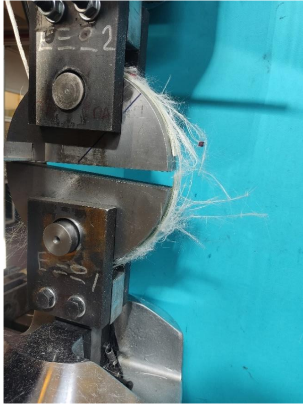
Σχήμα 4.21. Θραύση δοκιμίου με αποχωρισμό και συστροφή των ινών
