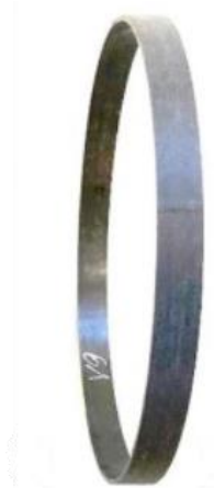
Σχήμα 4.2. Δοκίμιο χωρίς εγκοπές (πηγή: Laiarinandrasana et al., 2010)
