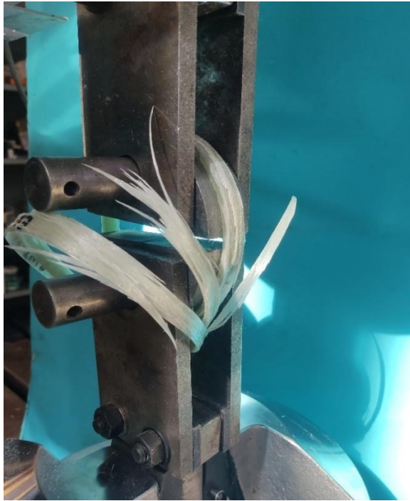
Σχήμα 4.22. Θραύση δοκιμίου με αποχωρισμό των στρώσεων
