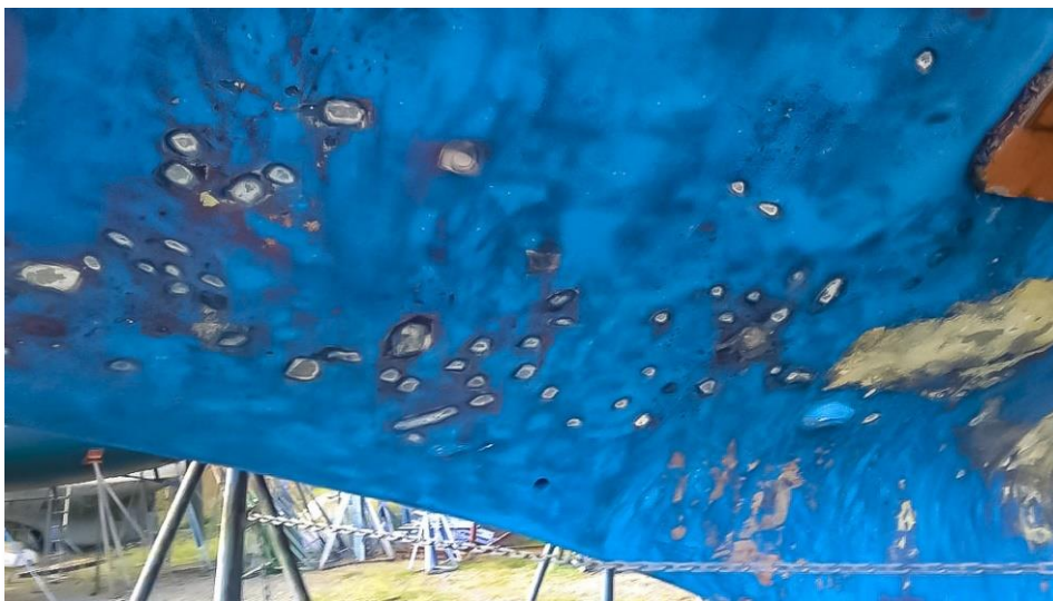
Σχήμα 1.5. Ωσμωση σε γάστρα από GRP (πηγή: https://www.sea-help.eu/en/guide/qfk-polyester-osmosis-boat-hull/ )
