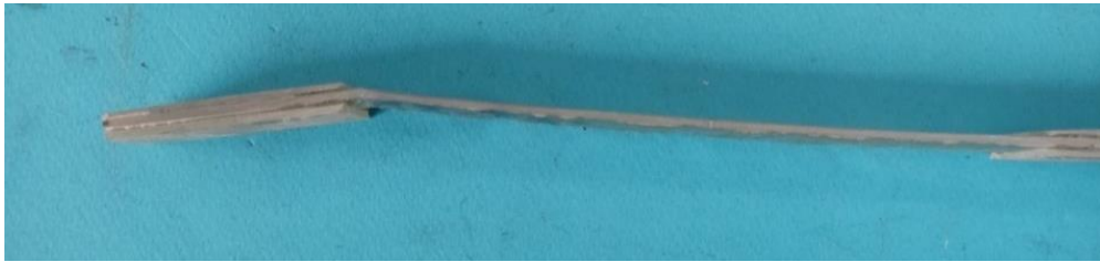
Σχήμα 5.8. Τυπική αστοχία δοκιμίου σε εφελκυσμό κάθετα στις ίνες – κάτοψη (πάνω), πλάγια όψη (κάτω)
