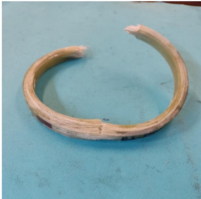
Σχήμα 4.20. Θραύση δοκιμίου κάθετα στις ίνες
