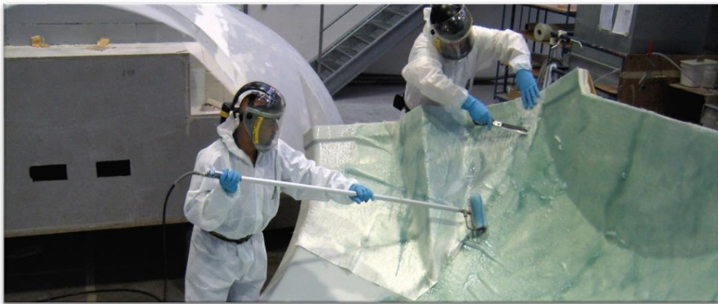
Σχήμα 1.6. Μέθοδος επίστρωσης με το χέρι (πηγή: https://www.fassmer.de/en/wind-power/production/hand-lay-up )
