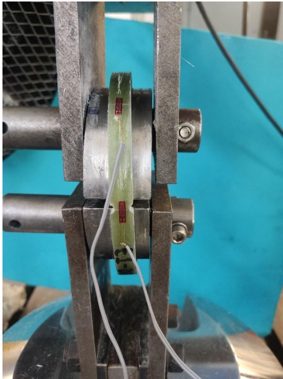
Σχήμα 4.24. Διάταξη με strain gauges και στις 0^\circ - δοκίμιο με εγκοπές (αριστερά) και χωρίς (δεξιά)
