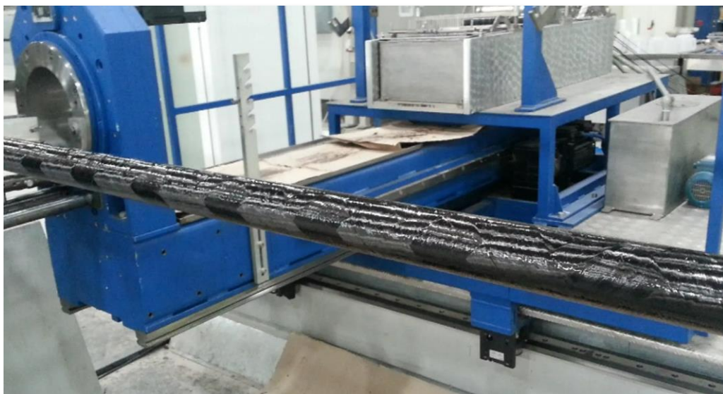
Σχήμα 3.1. Κύλινδροι από carbon fibers σε περιστρεφόμενο καλούπι της B&T Composites (πηγή: B&T Composites)
