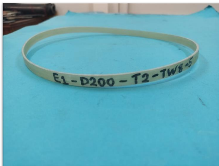
Σχήμα 4.10. Απορριφθέν δοκίμιο λόγω έντονης αρχικής παραμόρφωσης
