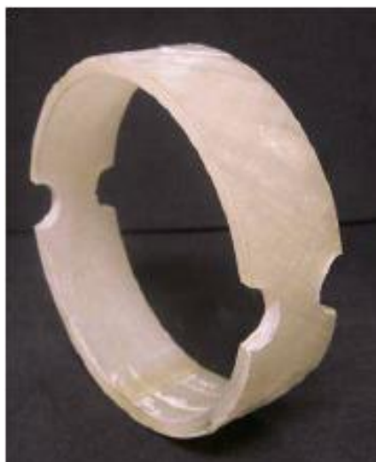
Σχήμα 4.1. Τυπικό δοκίμιο για τη δοκιμή διαιρούμενου δίσκου (πηγή: Ledjane et al., 2011)
