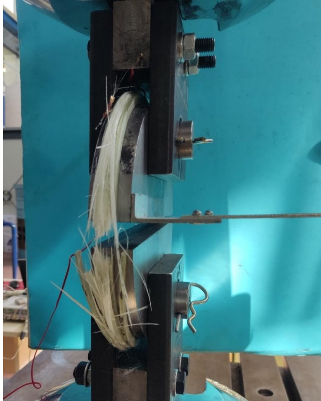
Σχήμα 4.19. Θραύση δοκιμίου κάθετα στις ίνες
