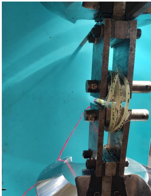
Σχήμα 4.23. Θραύση δοκιμίου με αποχωρισμό των στρώσεων
