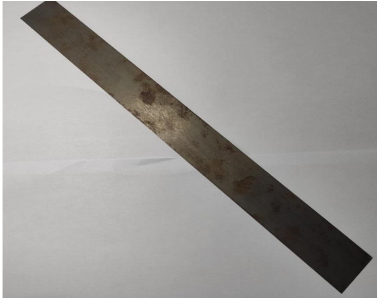
Εικόνα 4.1.5 Δείγμα Ηλεκτρικού χάλυβα 300 \times 30 \times 0.6 \text{ mm}^3 (τρίτο δείγμα)
